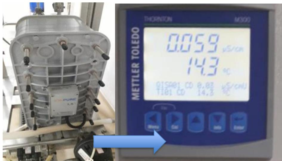
*Slika 3.16. Modul kontinuirane deionizacije i transmiter vrijednosti pročišćene vode M300
