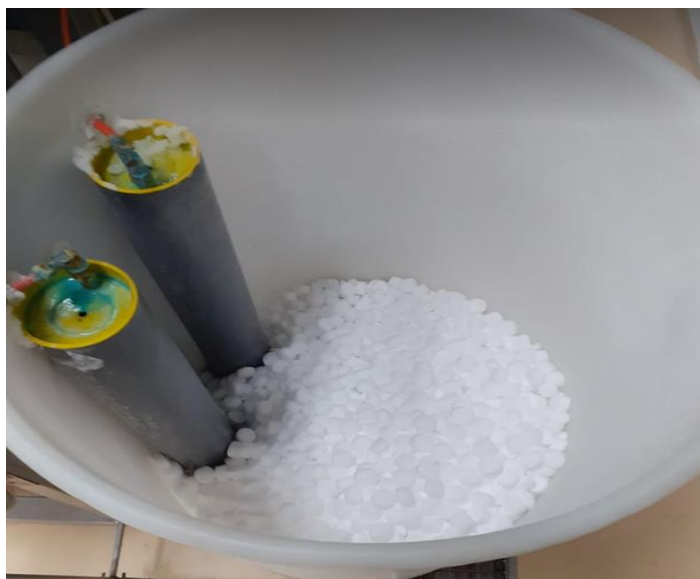
Slika 3.9. Spremnik s 7-10% otopinom NaCl (vlastiti izvor)
