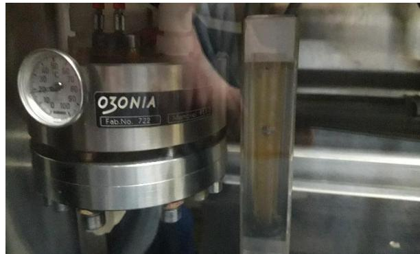
Slika 3.21. Čelija generatora ozona (vlastiti izvor)
