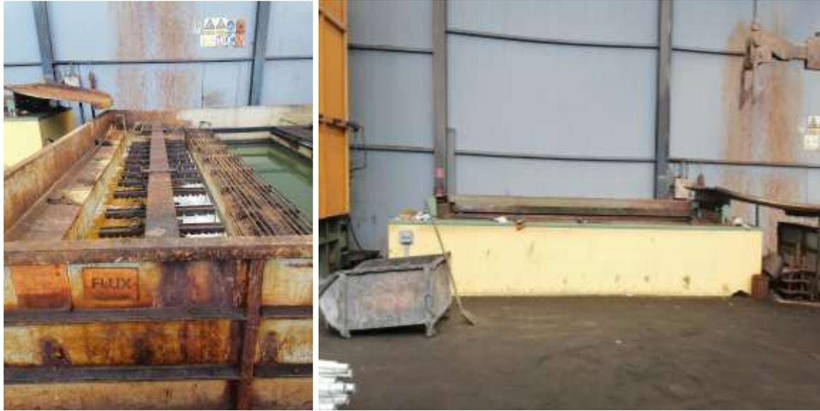
*Slika 16 – Flux (lijevo), sušenje (desno)*
