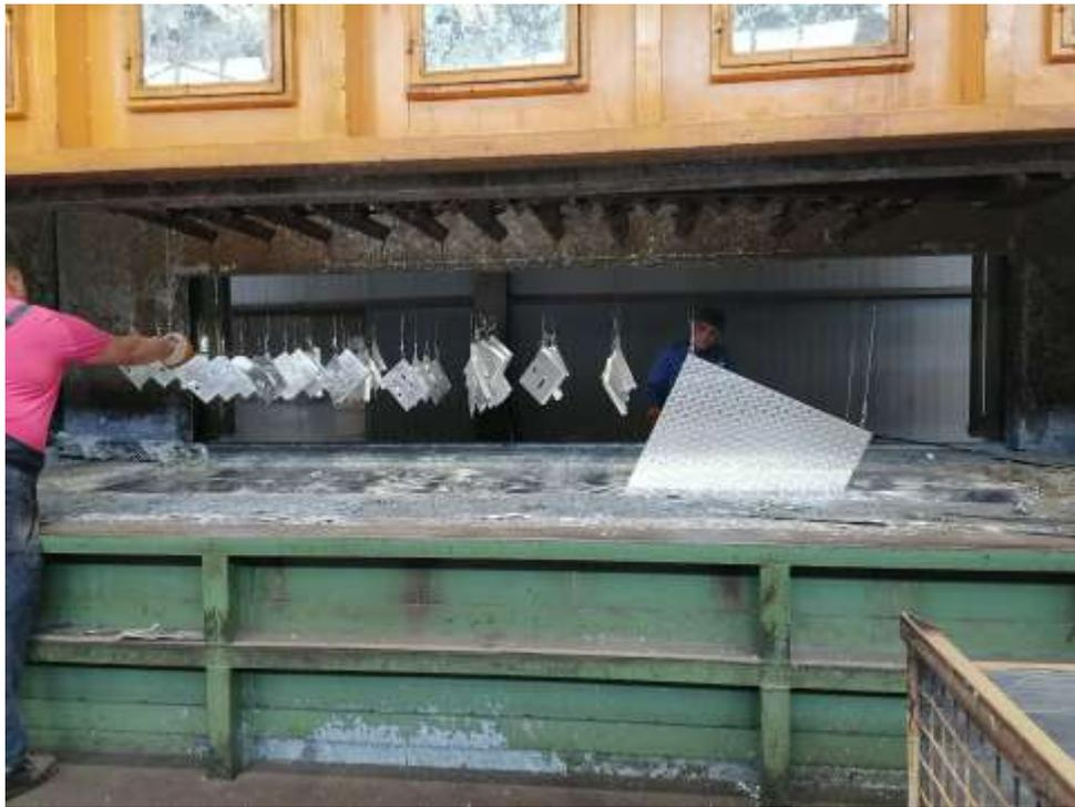
*Slika 17 - Uranjanje komada u rastaljeni Zn*
