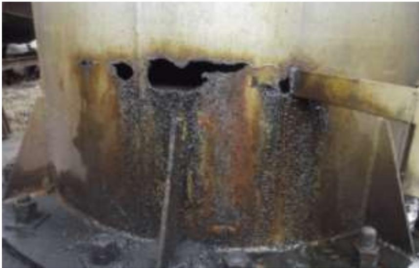
*Slika 5 - Primjer rupičaste korozije na strojarskom elementu valjkastog oblika*
