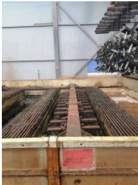
Slika 14 - Kada sa HCl
