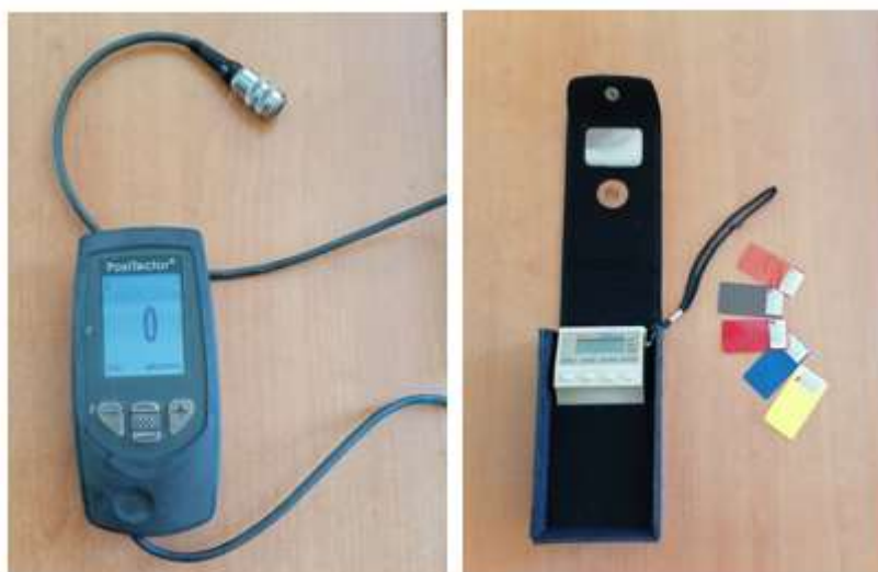
Slika 24 - Uređaji za mjerenje debljine prevlake Zn
