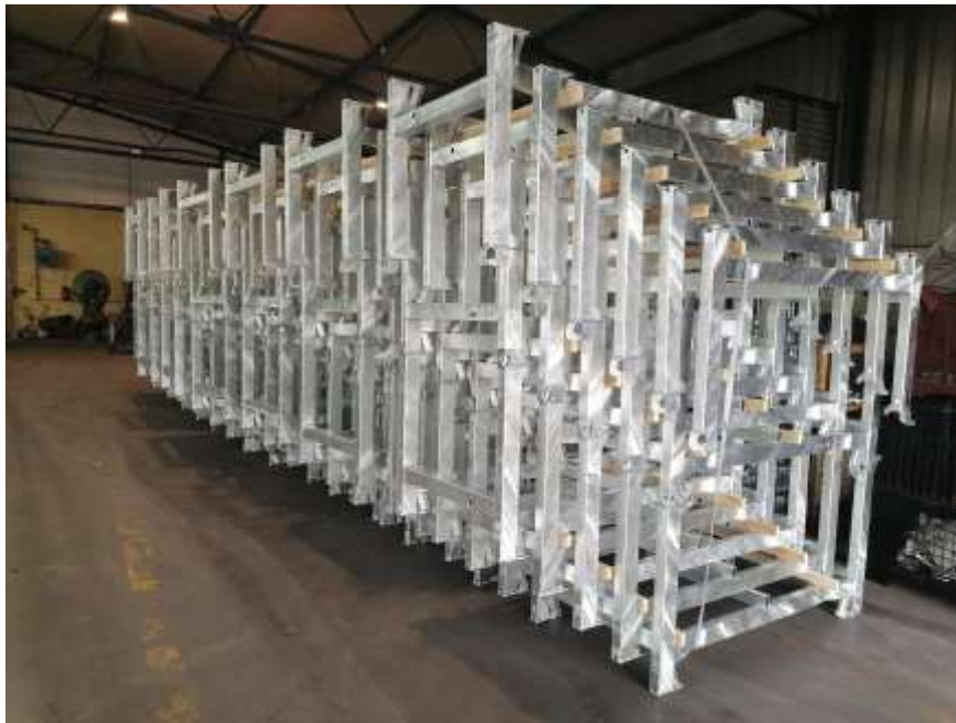
Slika 23 - Izgled proizvoda X nakon vrućeg pocinčavanja
