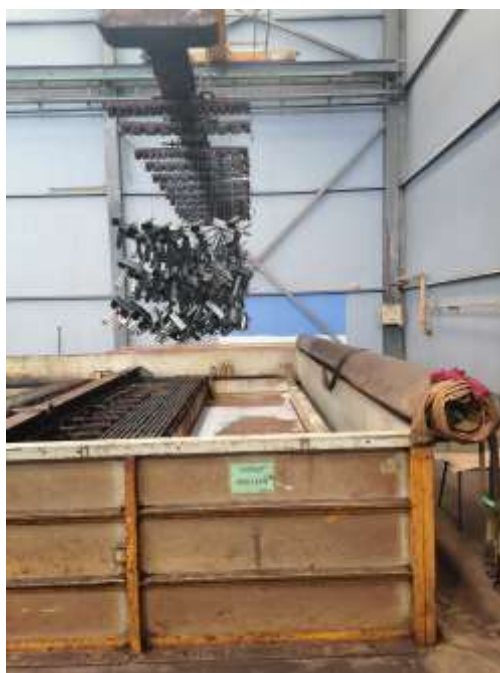
Slika 13 - Kada za odmašćivanje
