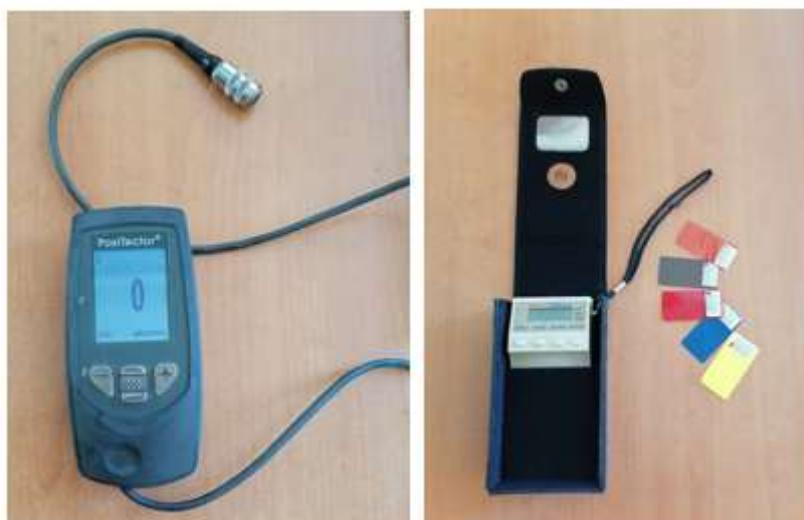
Slika 24 - Uređaji za mjerenje debljine prevlake Zn
