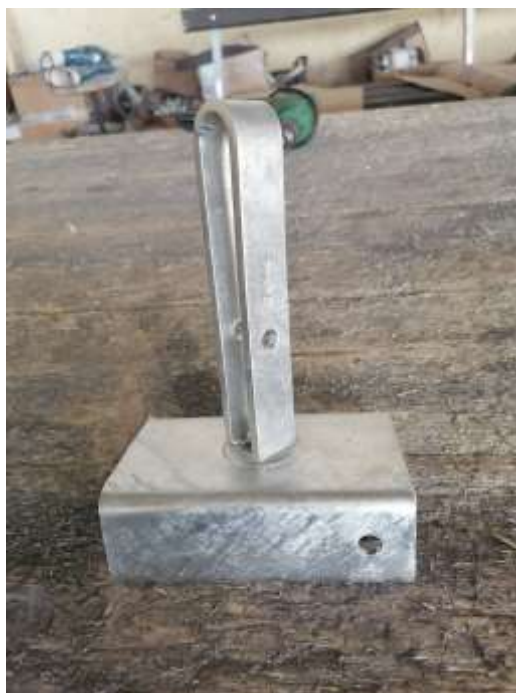
Slika 21 - Prihvatljivi izgled prevlake nakon pocinčavanja
