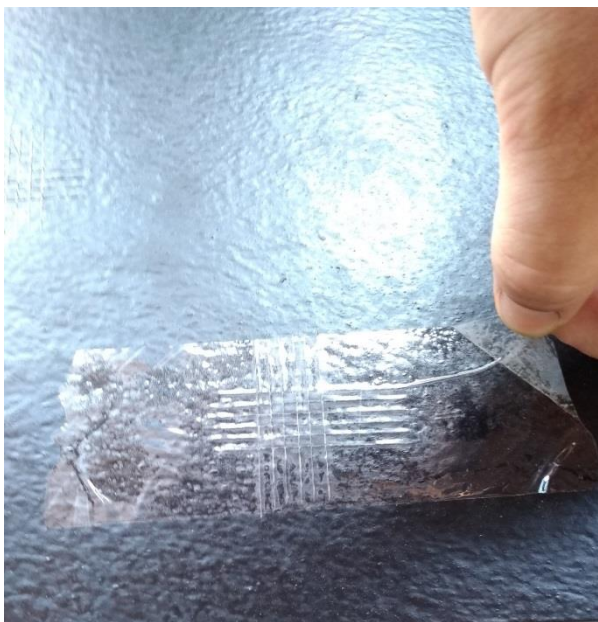
Slika 40: Nakon što je mrežica urezana i očetkana, preko nje se lijepi ljepljiva vrpca koja se tada naglo skida
