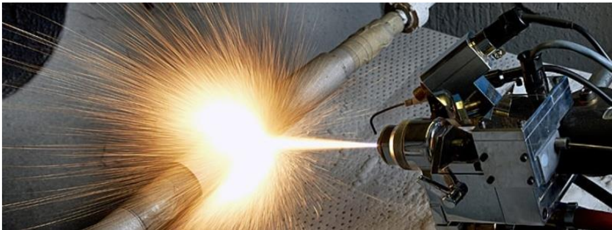
Slika 13: Postupak nanošenja metalne prevlake vrućim prskanjem [19]
