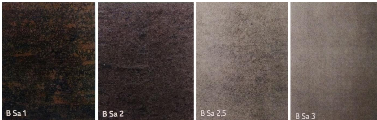
Slika 16: Stupnjevi stanja površine B sa slike 15 nakon pripreme mlazom abraziva prema HRN EN ISO 8501-1:2007[1][21]
