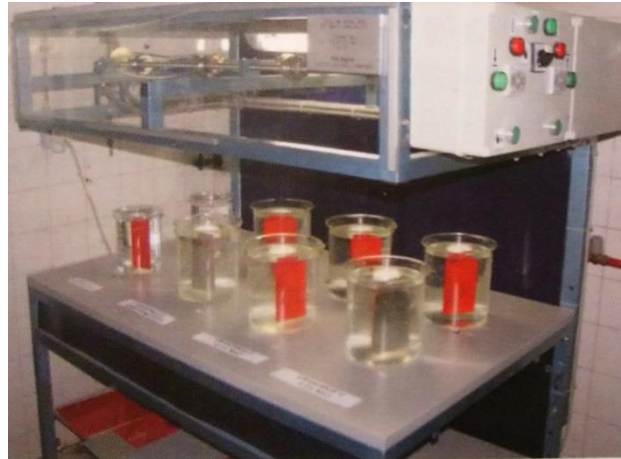
Slika 24: Uranjanje uzoraka na 10 minuta [1]
