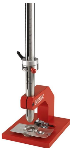
Slika 21: Uređaj za ispitivanje premaza na udar prema normi HRN EN ISO 6272 [26]
