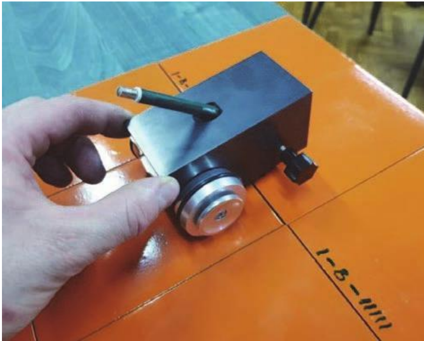
Slika 20: Mjerenje tvrdoće premaza olovkama - olovka se povlači po uzorcima pomoću posebnog držača bez dodavanja pritiska [25]
