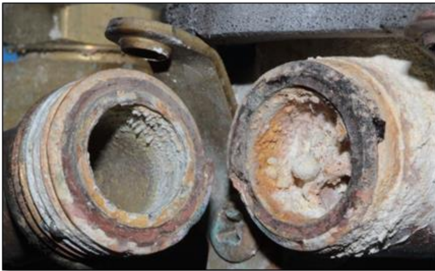
Slika 7: Decinkacija mjedi - pojava crvenkastog obojenja i bijelog depozita kao pokazatelj decinkacije [12]
