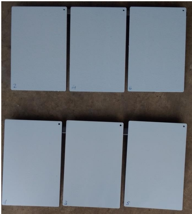
Slika 35: Uzorci nakon nanošenja temeljnog premaza – na uzorke 2, 4, 6 premaz je nanesen valjkom, a na uzorke 1, 3 i 5 prskanjem
