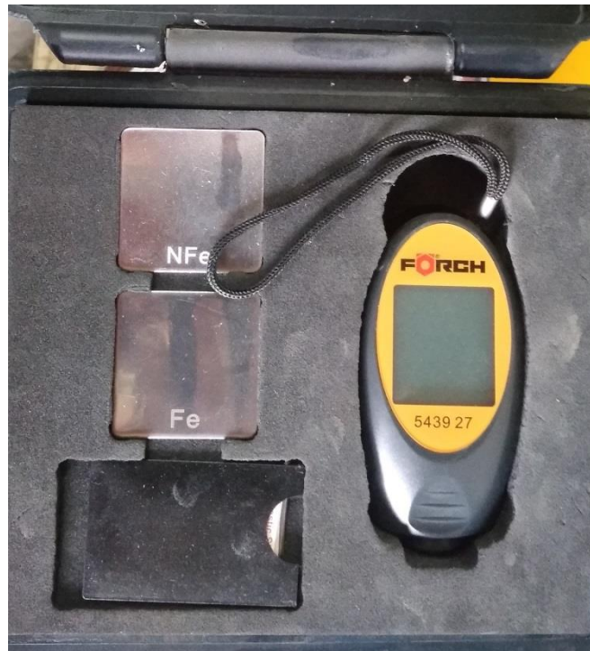
Slika 32: Förch uređaj za mjerenje debljine suhog filma premaza
