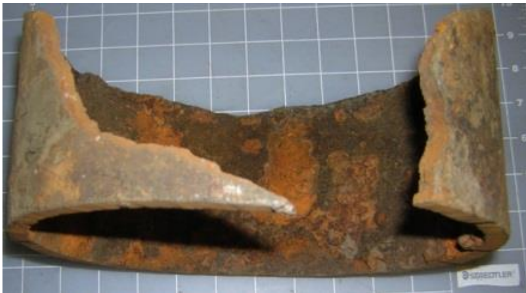
Slika 8: Grafitizacija sivog lijeva - često se javlja na ukopanim cijevima [13]
