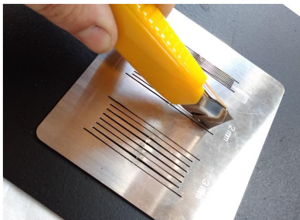
Slika 39: Urezivanje mrežice na uzorke pomoću šablone
