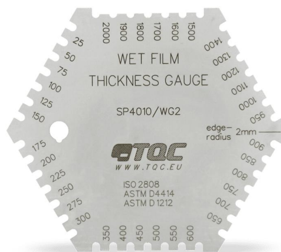
Slika 18: "češalj" za mjerenje debljine mokrog filma premaza [23]
