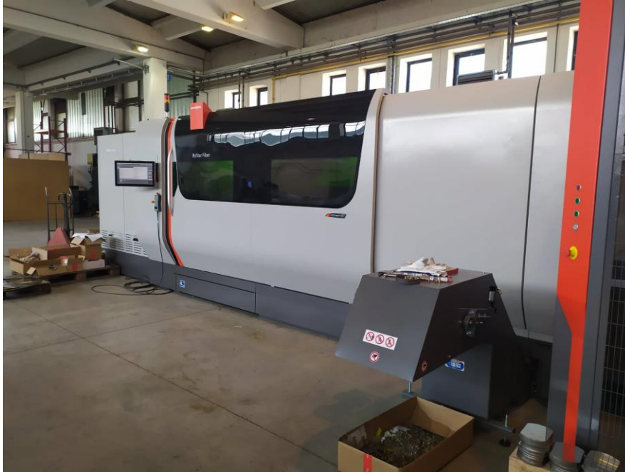
Slika 26: Bystronic Bystar Fiber 3015 – 10 kW u proizvodnom pogonu tvrtke „Dekor tvornica rasvjete d.o.o.“
