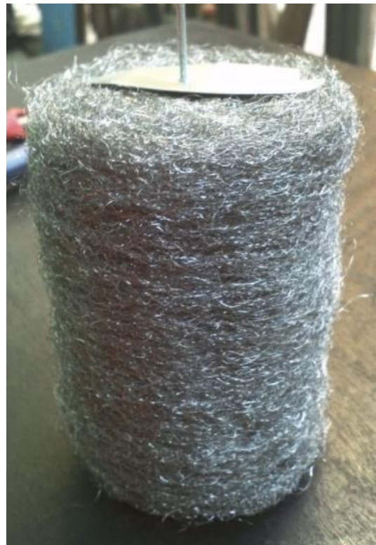
Slika 2.42 Primjer regeneratora (potiskivača)
