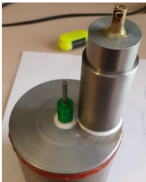
Slika 3.15 Spoj radnog klipa i cilindra
