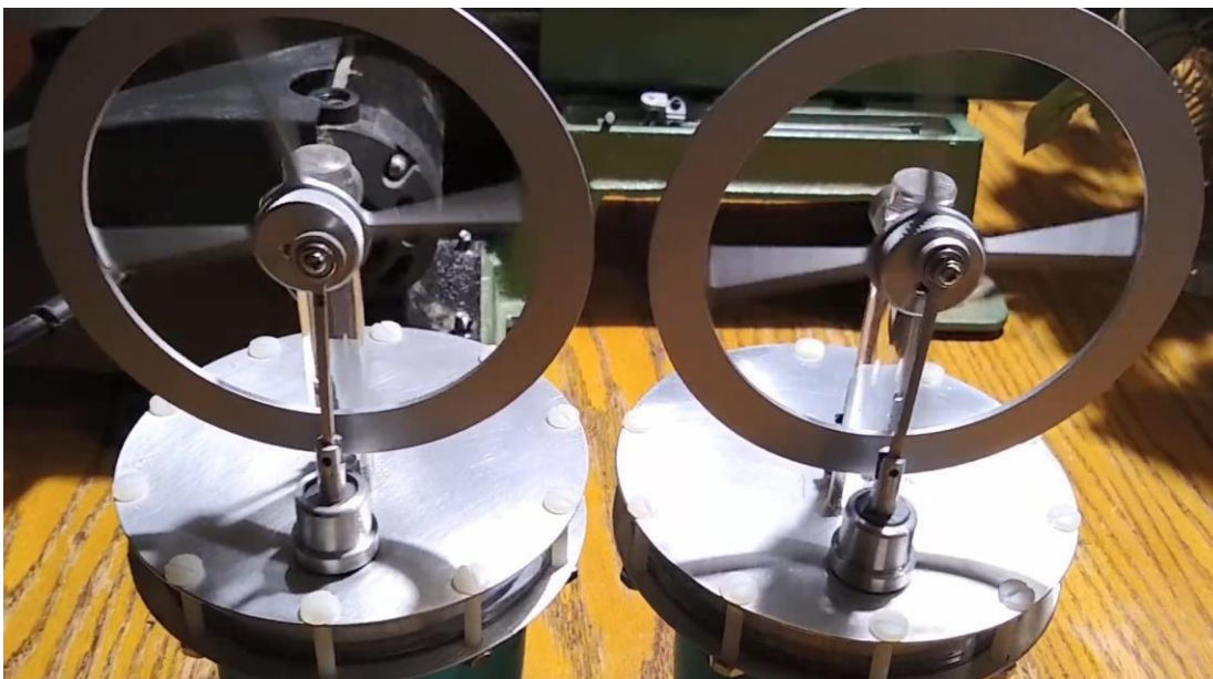
Slika 2.43 Dva LTD stirlinga – bez i sa regeneratora
