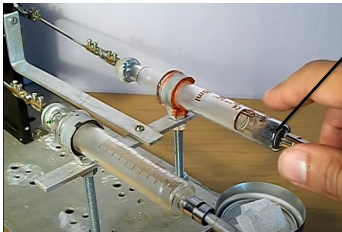
Slika 2.46 \alpha -stirling sa fiksnim regeneratom
