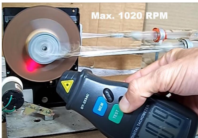
Slika 2.48 Broj okretaja \alpha -stirlinga bez regeneratora
