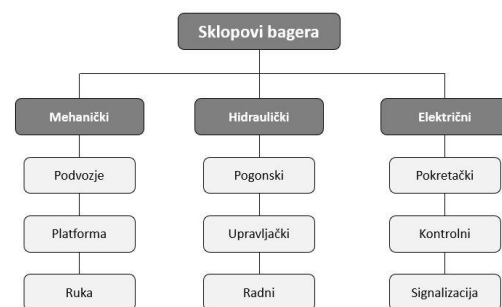
Slika 2.3 Podjela sklopova bagera
