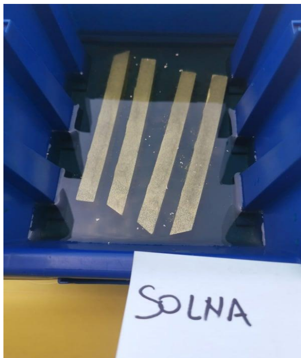
Slika 9.6. Uzorci uronjeni u solnu kiselinu 24,5%
