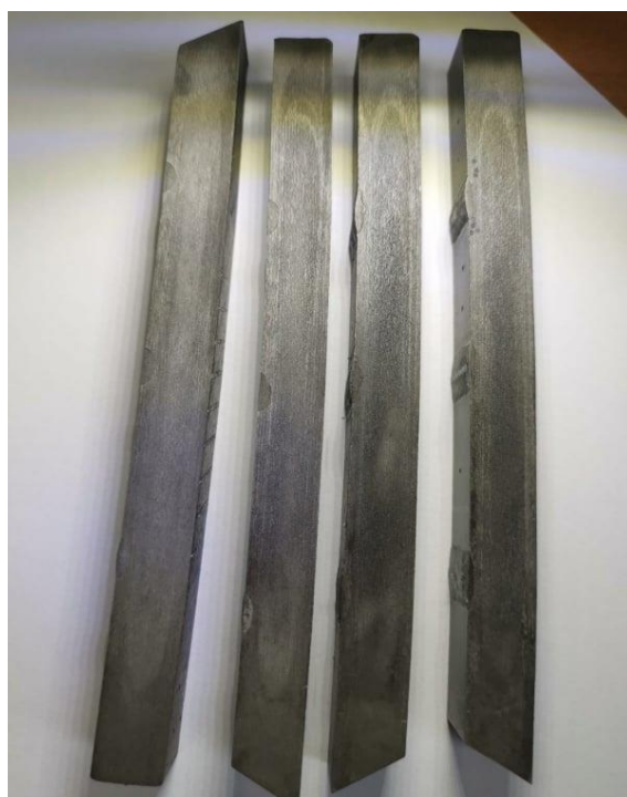
Slika 9.7. Uzorci sa makroizbruscima
