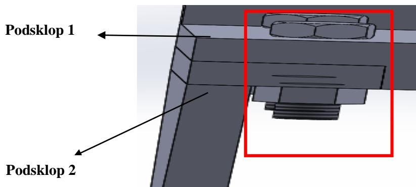
4. **Korak** – izrađuje se podsklop 3. Lijevi nosač bubnja, bubanj i desni nosač bubnja se zavaruju i nakon toga montiraju kroz provrt  $\varnothing 35,2$  mm.
