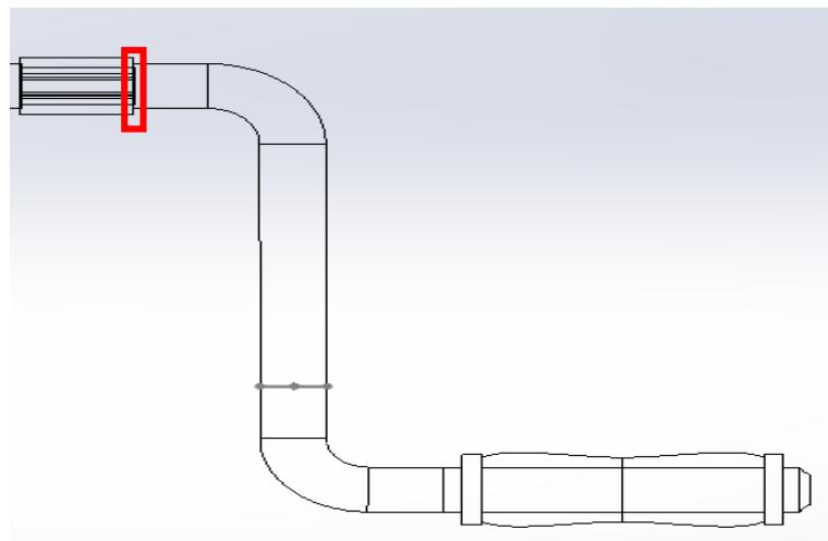
7. Korak – zavaruje se savijena cijev i ručka za okretanje
