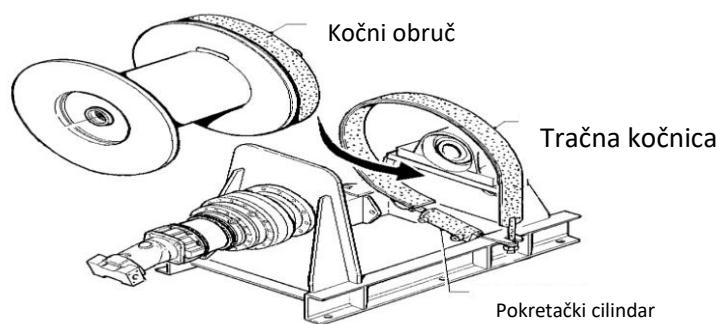
Slika 2.3 Tračna kočnica
