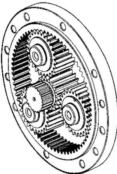
Slika 2.22 Planetarni prijenosnici
