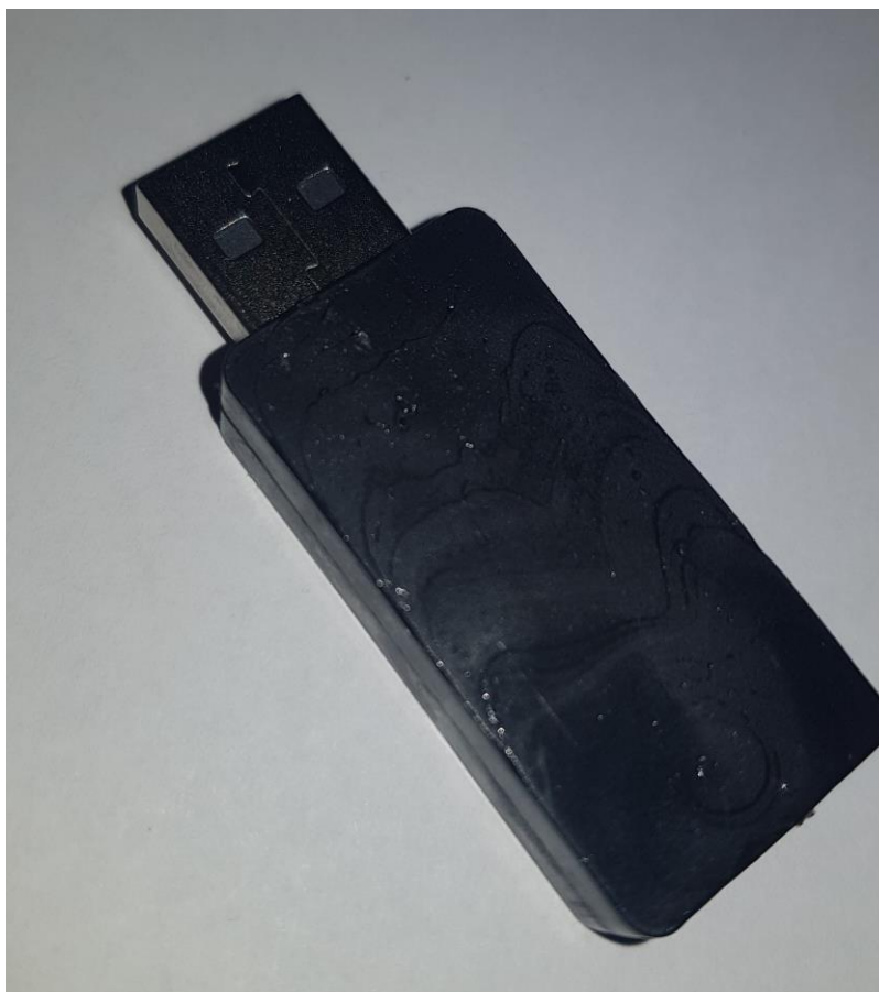
Slika 56. Tekstura površine nakon 2. lijevanja
