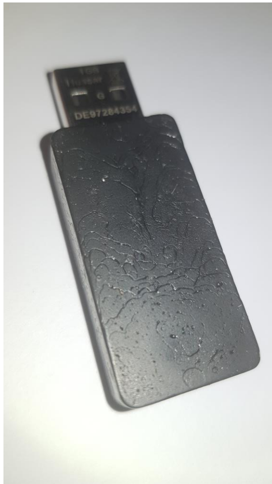
Slika 55 Pojava nakon prvog lijevanja
