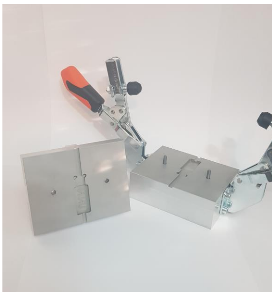
Slika 48. Sklop kalupa - otvoreni
