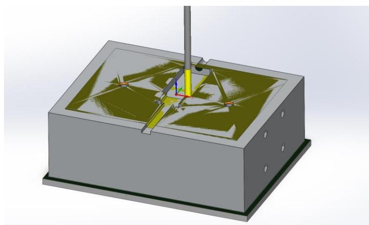
Slika 30 Grubo i fino glodanje prostora za kućište USB sticka
