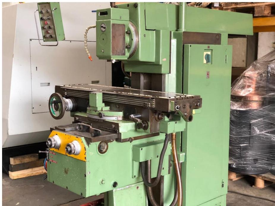
*Slika 24 Klasična glodalica*
