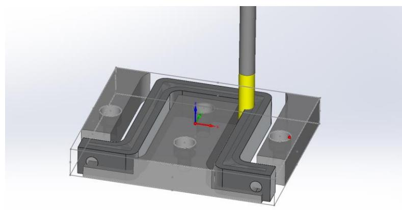
Slika 47 Izrada unutarnje konture
