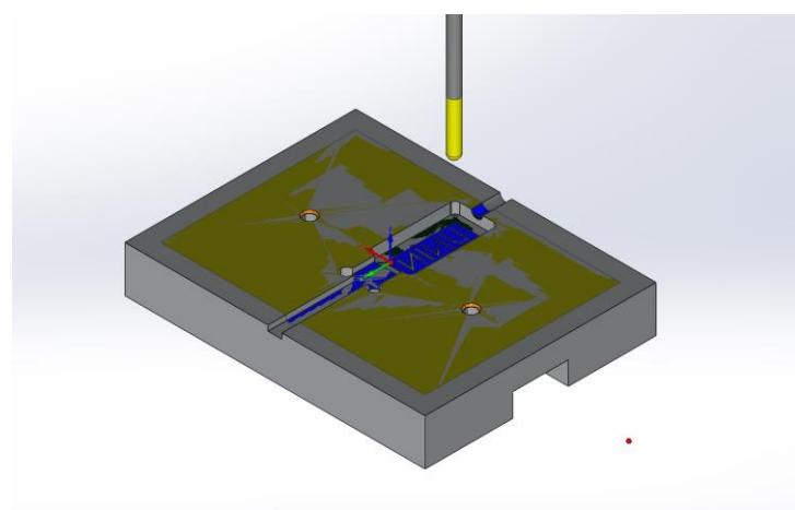
Slika 42 Izrada ulijevnog kanala
