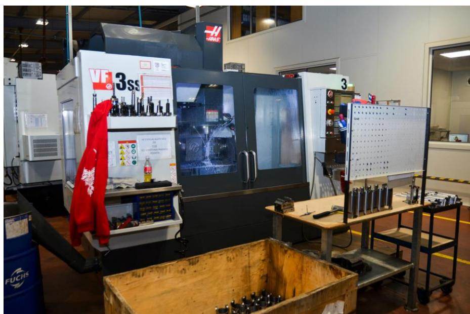
*Slika 25. CNC glodalica*
