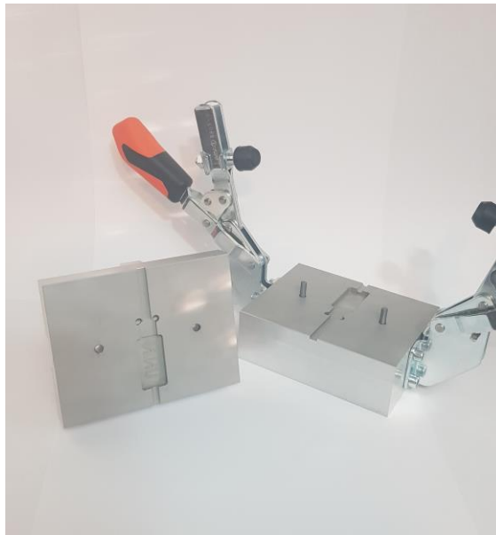
Slika 48. Sklop kalupa - otvoreni
