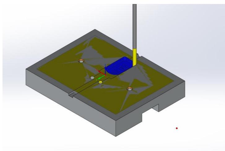
Slika 41 Izrada otvora za kućište USB sticka
