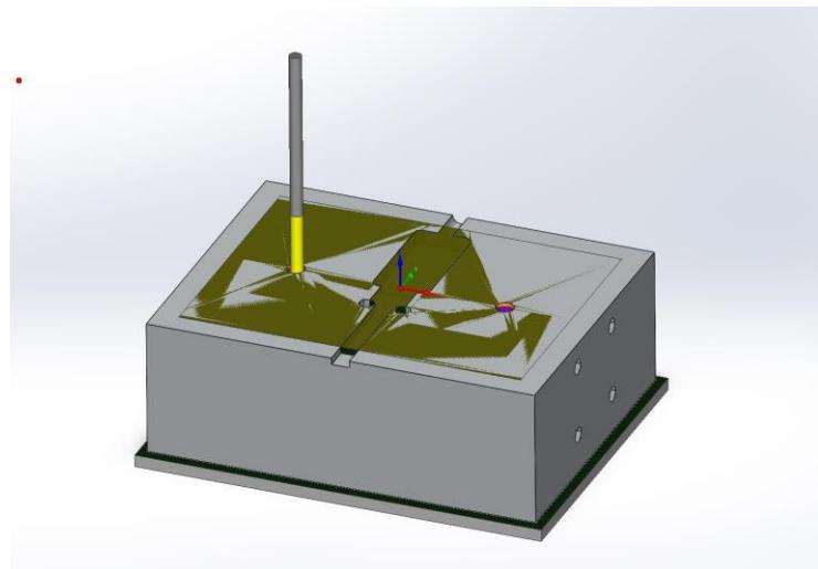
Slika 29 Izrada provrta za zatike
