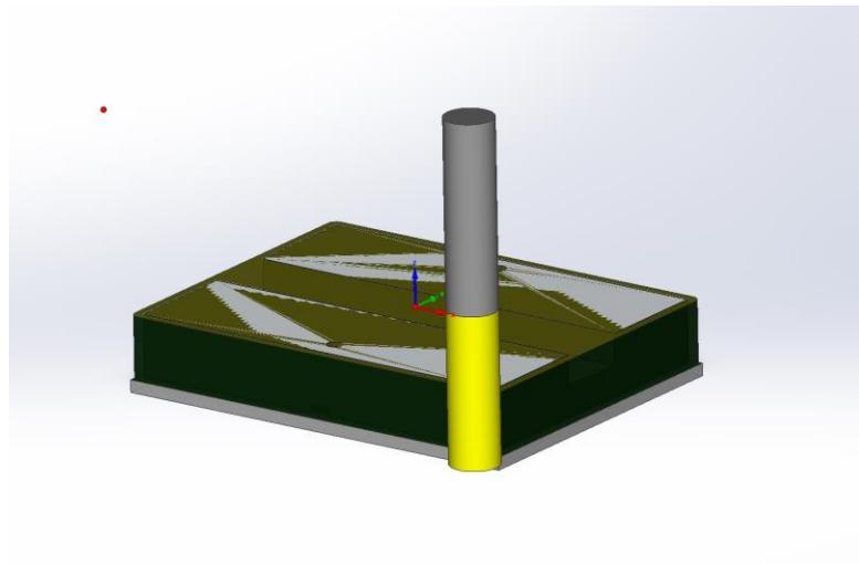
Slika 35 Glodanje vanjske konture na mjeru
