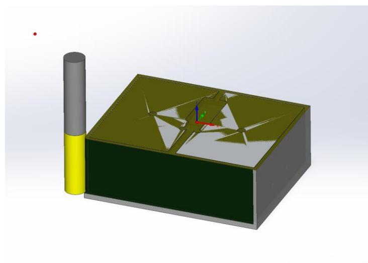
Slika 27. Grubo i fino glodanje vanjske konture na gotovu mjeru
