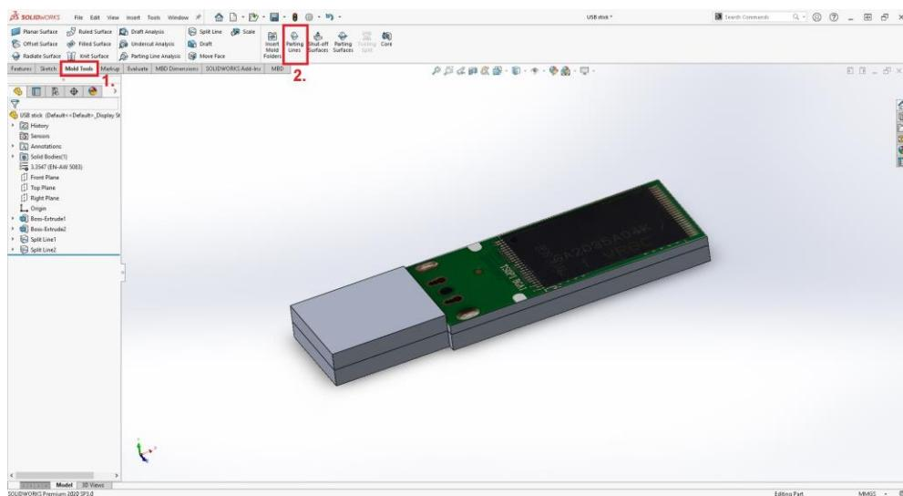
*Slika 7. Način pokretanja alata za izradu razdjelne linije*
