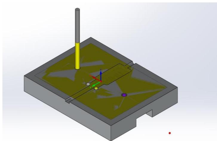
Slika 40 Izrada provrta za zatike
