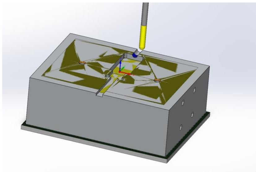
Slika 31 Izrada kanala za ulijevanje polimerne mase
