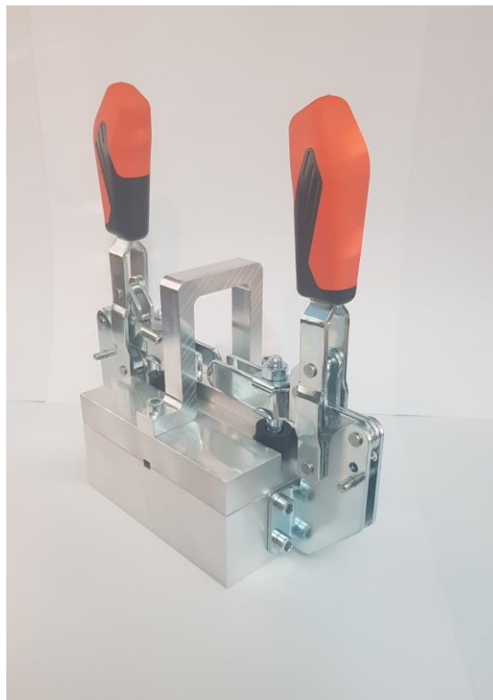
Slika 49. Sklop kalupa – zatvoreni
