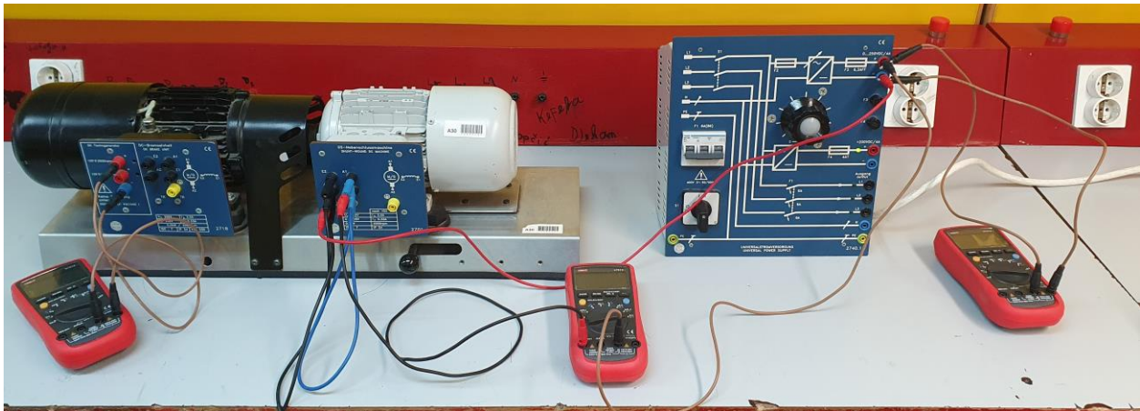
Slika 7.4. Spojeni elementi prema shemi pokusa praznog hoda
