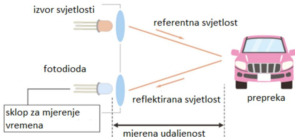
Slika 3.2 Princip rada ToF tipa LIDAR senzora [8]
