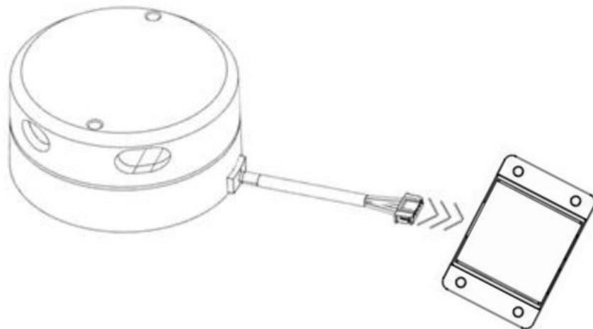
Slika 4.2 Povezivanje LIDAR senzora s USB adapterom [6]
