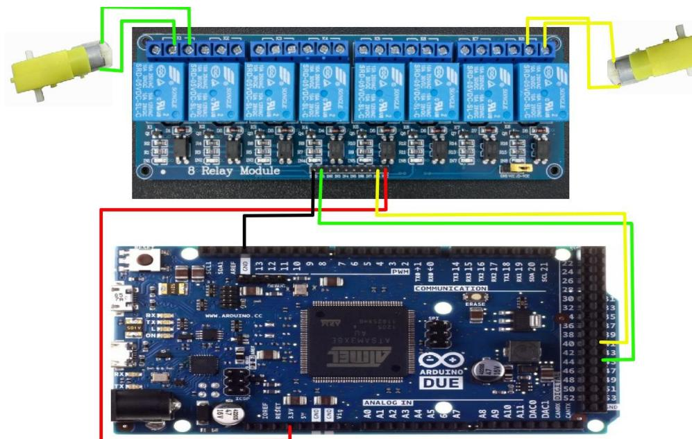
*Slika 4.12 Povezivanje relejnog modula s Arduinom i motorima*
