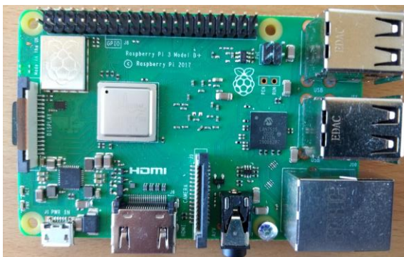
Slika 3.14 Raspberry Pi 3B+
