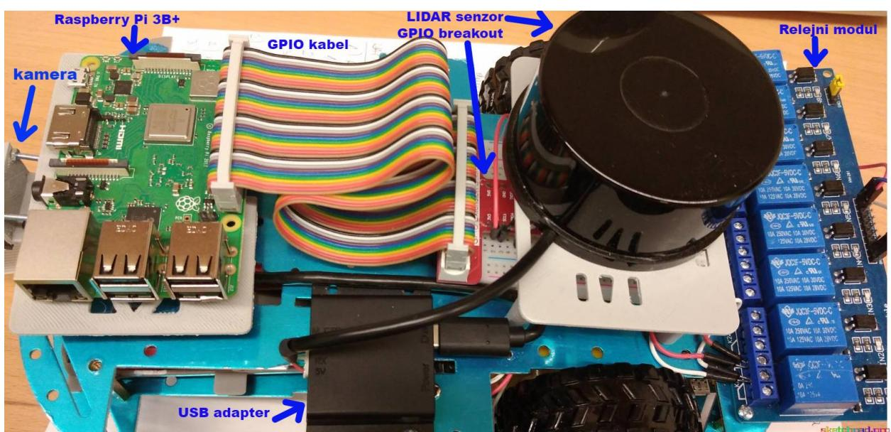
Slika 2.2 Gornji dio platforme s korištenim dijelovima
