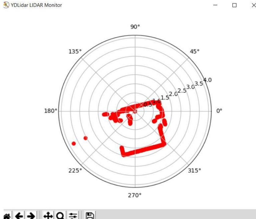
Slika 4.6 Grafički prikaz skeniranja LIDAR-a
