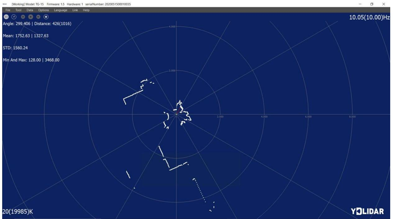
Slika 4.4 LIDAR-primjer skeniranja
