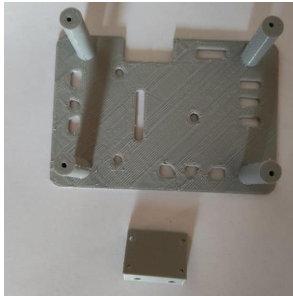
Slika 3.8 Postolje za LIDAR i kameru
