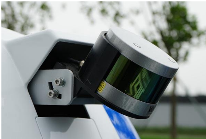
Slika 3.4 LIDAR s višestrukim zrakama svjetlosti [9]
