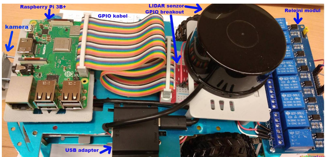
Slika 2.2 Gornji dio platforme s korištenim dijelovima
