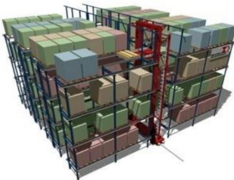
Slika 20. Telescopic satellite sustav
