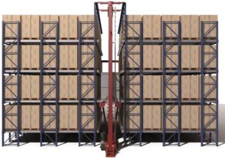
Slika 17. Multiple deep AS/RS
