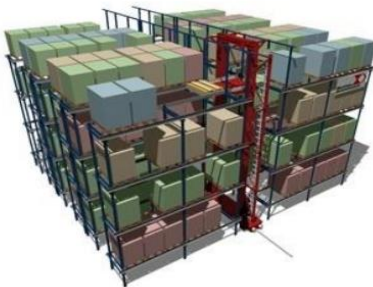
Slika 20. Telescopic satellite sustav
