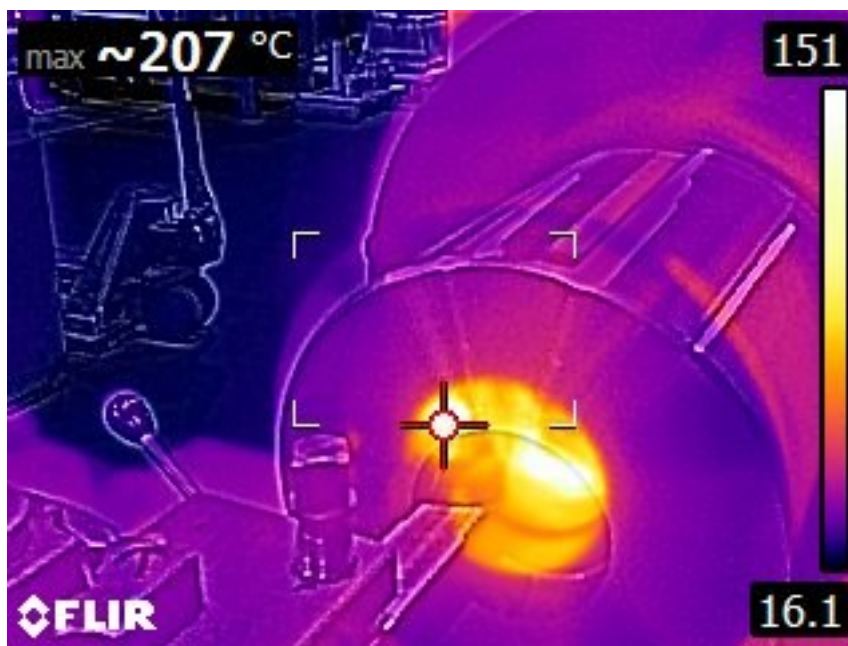
Slika 7-3 - Primjer obrade odvajanjem čestica pri unutarnjem tokarenju
