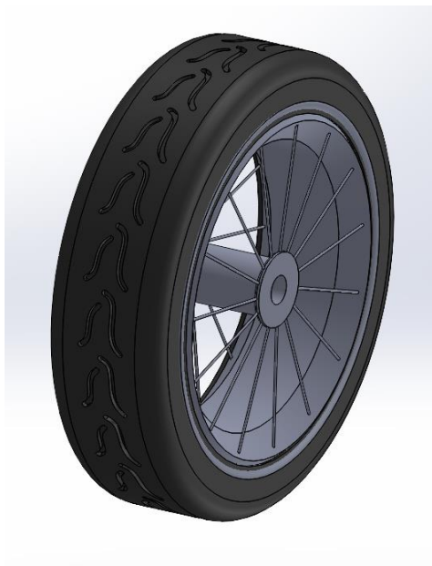
Slika 27. Prikaz kotača kvadricikla (SolidWorks)
