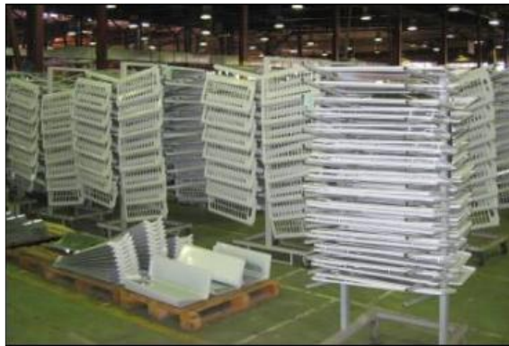
Slika 8 - Gomilanje proizvoda uslijed prekomjerne proizvodnje
