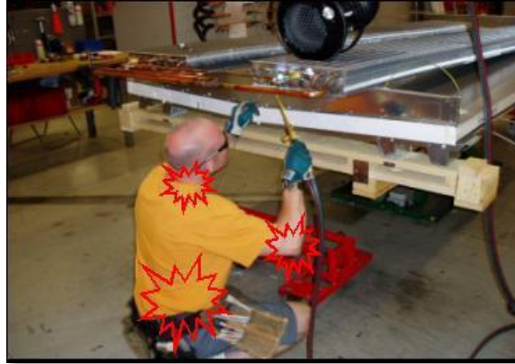
Slika 13 - Nepotrebni pokreti zbog loše izvedbe postolja
