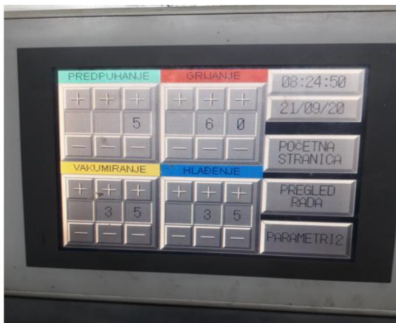
Slika 8. Vrijeme trajanja pojedinih dijelova postupka termoformiranja
