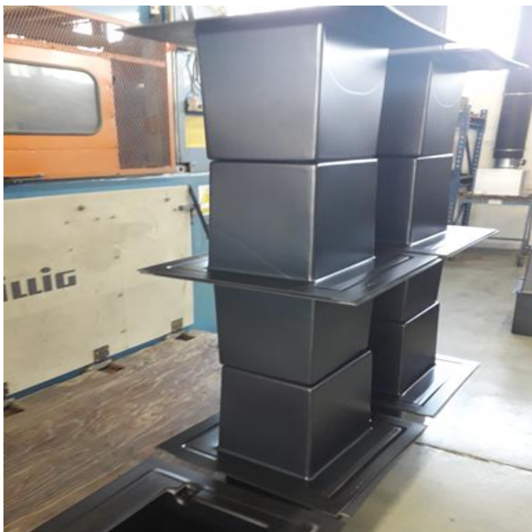
Slika 9. Polistirenska posuda dobivena postupkom termoformiranja
