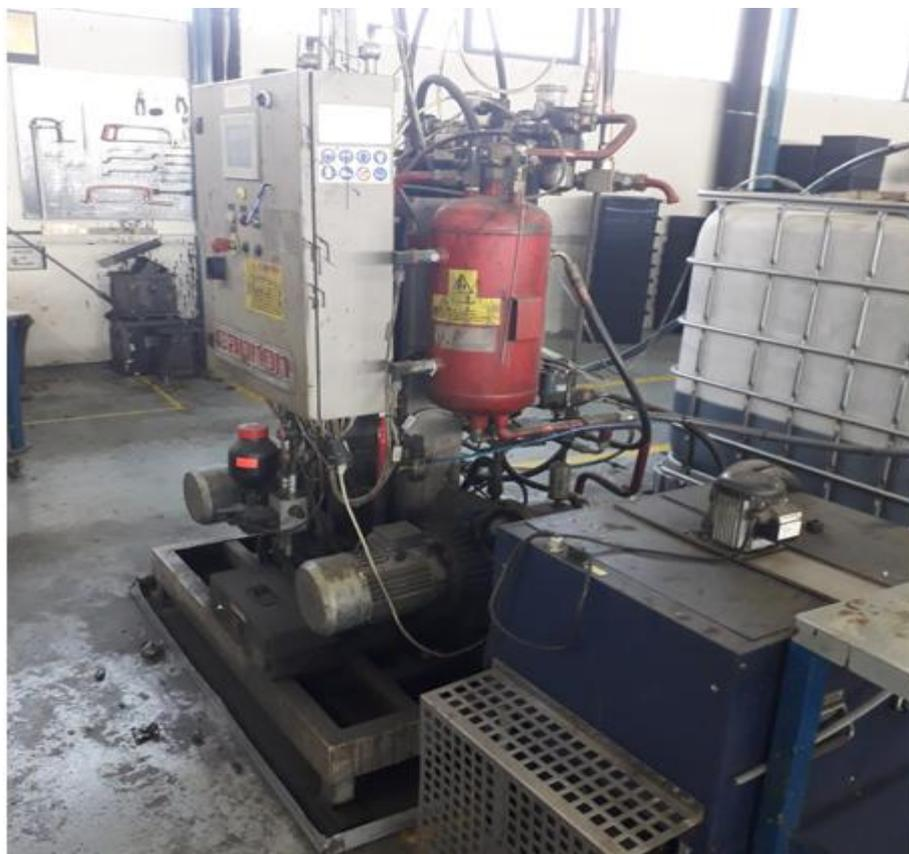
*Slika 20. Visokotlačni uređaj za doziranje Cannon AP - 30*
