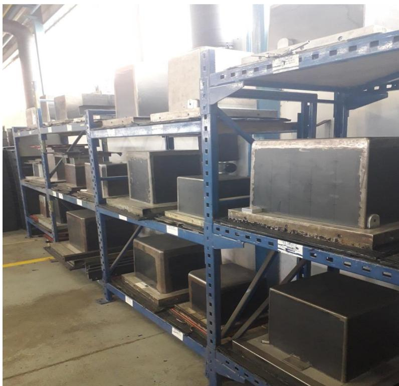
*Slika 7. Skladište kalupa za termoformiranje*
