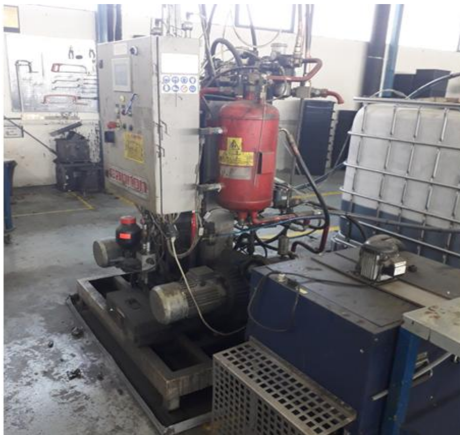
Slika 20. Visokotlačni uređaj za doziranje Cannon AP - 30
