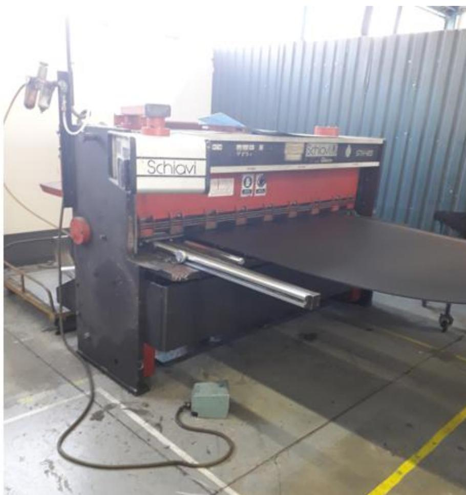
*Slika 4. Hidraulične škare Schiavi GTH 420*
