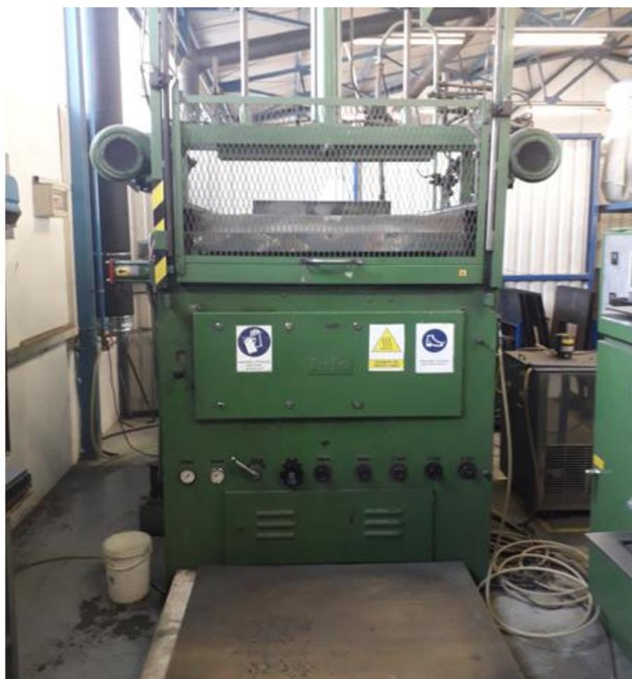
*Slika 6. Stroj za termoformiranje*
