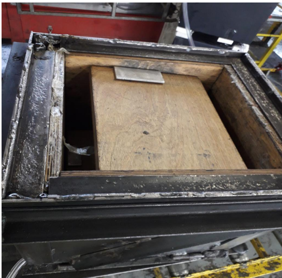
Slika 17. Zatvoreni kalup s umetnutom drvenom jezgrom
