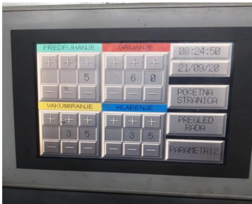
*Slika 8. Vrijeme trajanja pojedinih dijelova postupka termoformiranja*
