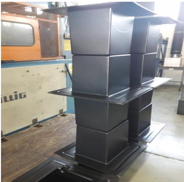
*Slika 9. Polistirenska posuda dobivena postupkom termoformiranja*
