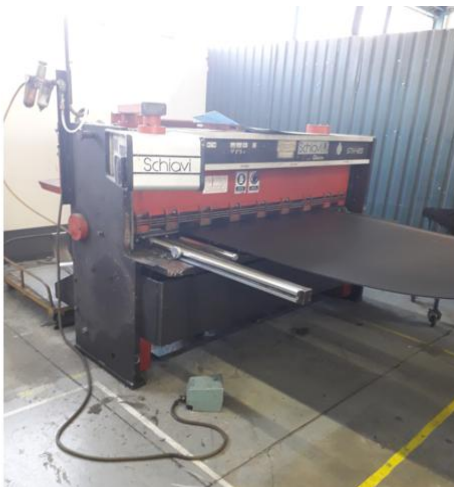
Slika 4. Hidraulične škare Schiavi GTH 420
