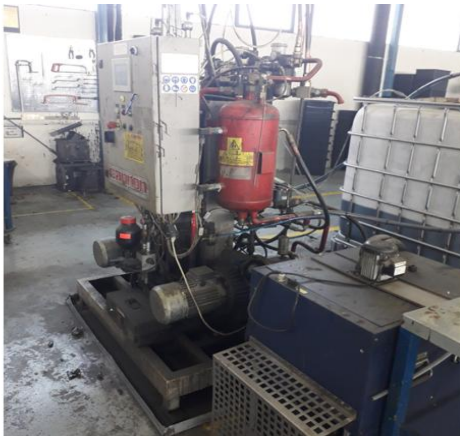
Slika 20. Visokotlačni uređaj za doziranje Cannon AP - 30
