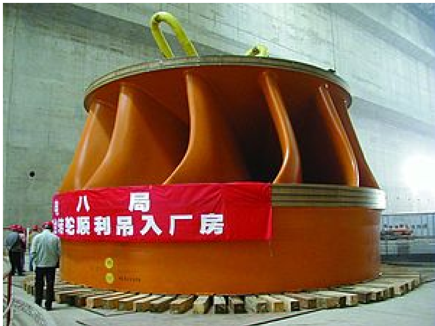
Slika 2.2.3. Jedna od 34 turbine sa hidroelektrane Tri klanca [9].
