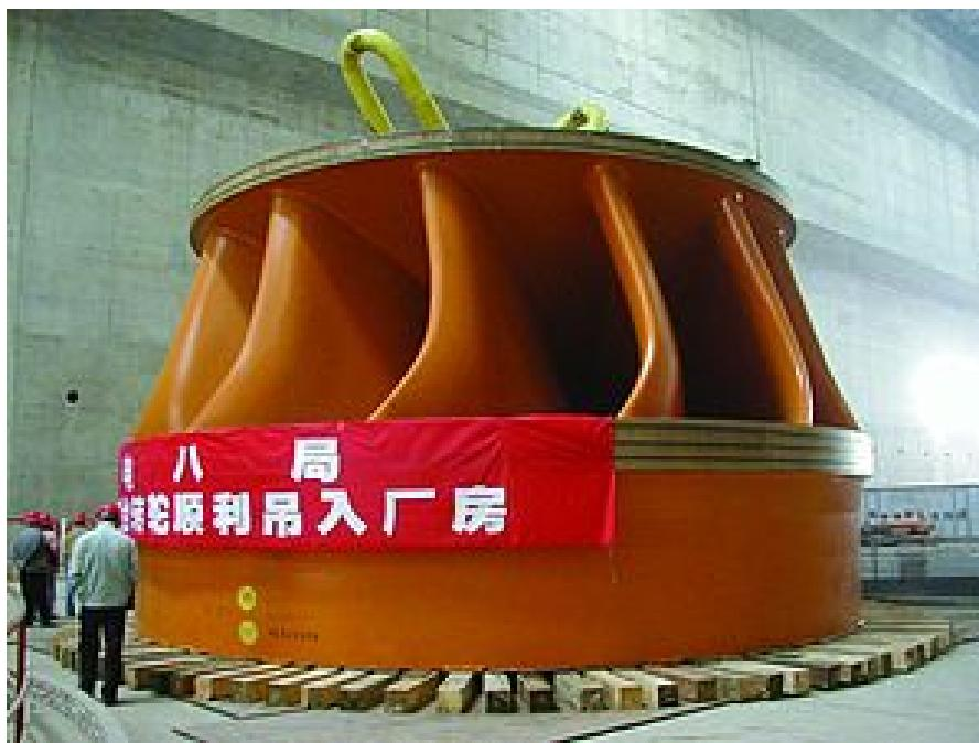
Slika 2.2.3. Jedna od 34 turbine sa hidroelektrane Tri klanca [9].
