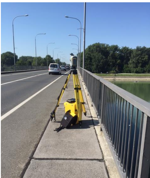
Slika 31. Skeniranje cestovnog mosta
