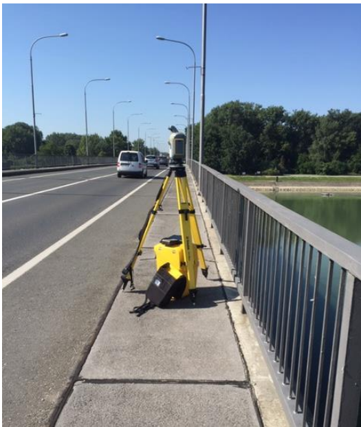
Slika 31. Skeniranje cestovnog mosta
