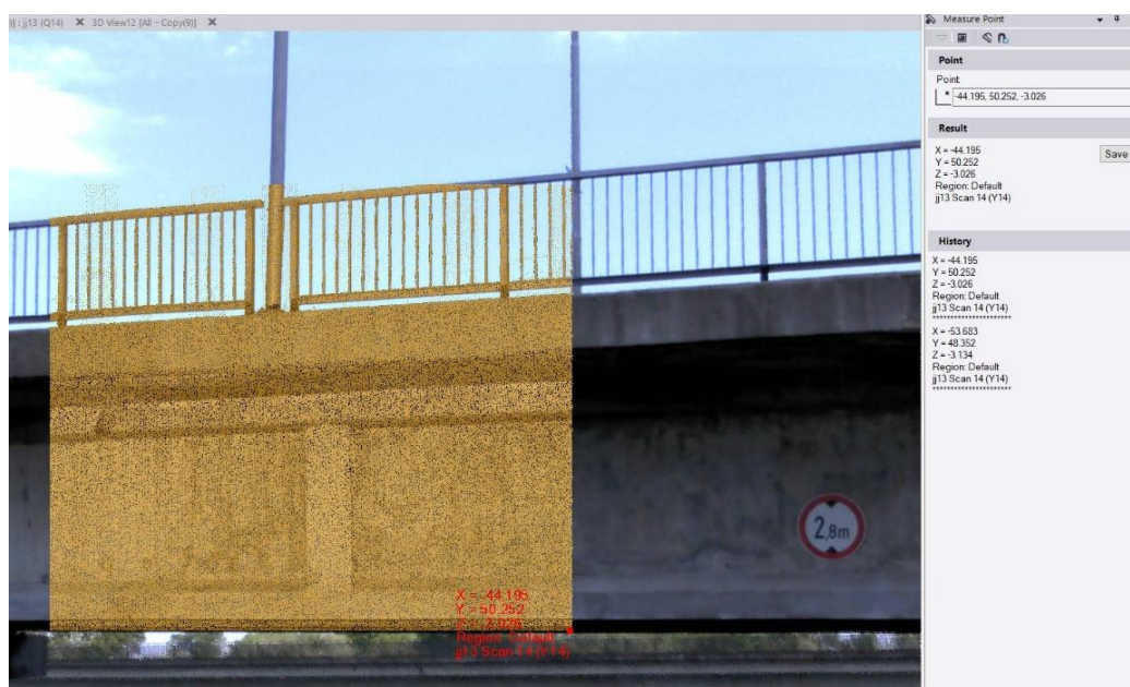
Slika 36. Očitovanje dimenzija pomoću oblaka točaka u Trimble Business Center softveru
