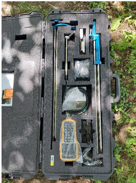
Slika 3.13. Prikaz dijelova mjernog uređaja FlowTracker 2
