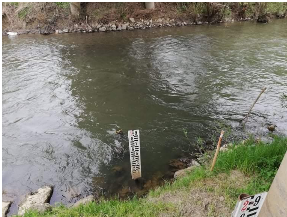
Slika 3.8. Prikaz rijeke Bednje na lokaciji u Ključu, uz prikaz mjerne letve
