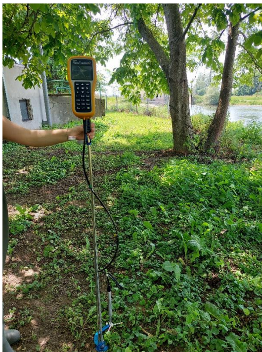
Slika 3.14. Prikaz mjernog uređaja FlowTracker 2
