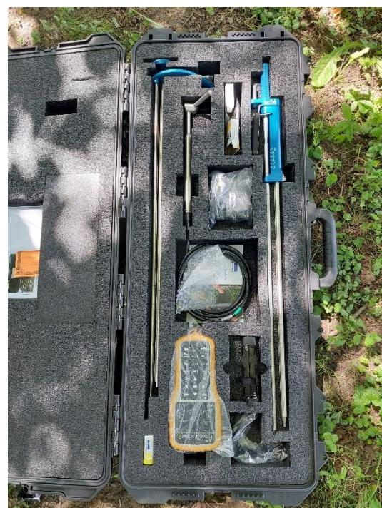
*Slika 3.13. Prikaz dijelova mjernog uređaja FlowTracker 2*
