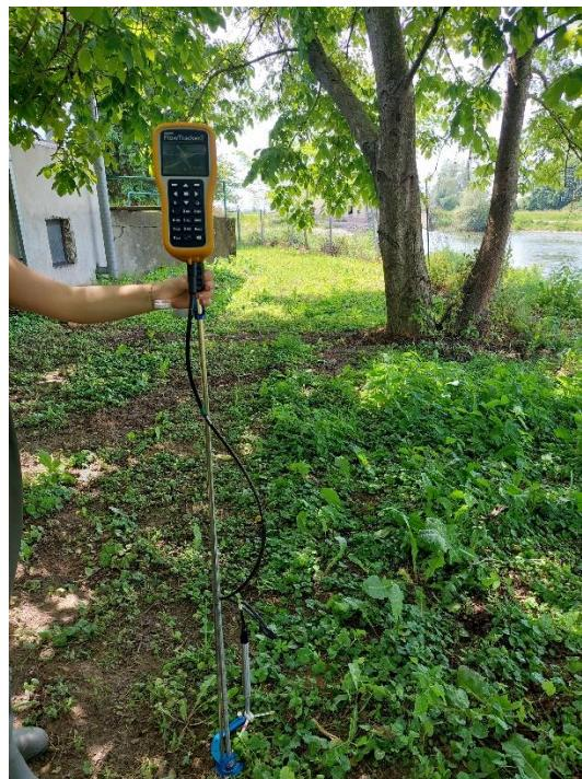
Slika 3.14. Prikaz mjernog uređaja FlowTracker 2
