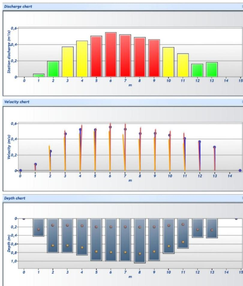
Slika 3.28. Grafički prikazi rezultata mjerenja u Željeznici – prikaz protoka, brzina i dubina na svakoj mjerenoj stanici
