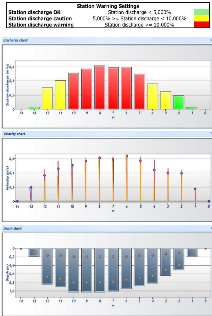
Slika 3.20. Grafički prikazi rezultata mjerenja u Ludbregu – prikaz protoka, brzina i dubina na svakoj mjernoj stanici
