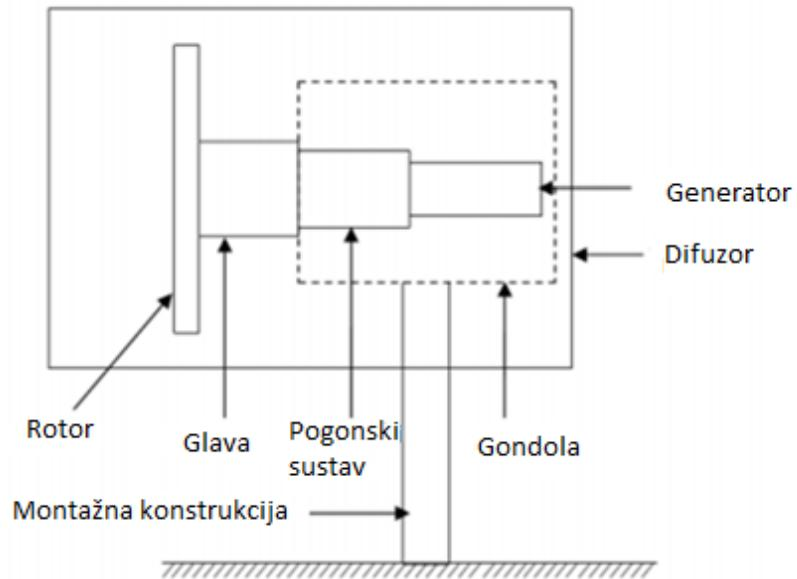
*Slika 2.1. Općeniti prikaz hidrokinetičke turbine [2]*
