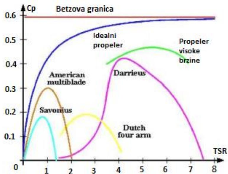
Slika 2.13. Usporedba  $C_p$ - $TSR$  krivulja različitih turbina [7]
