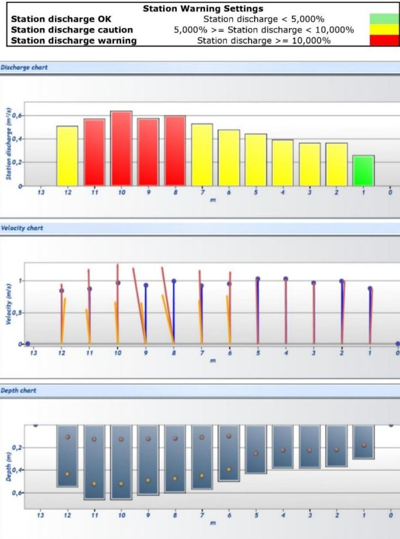
Slika 3.24. Grafički prikazi rezultata mjerenja u Ključu – prikaz protoka, brzina i dubina na svakoj mjerenoj stanicu
