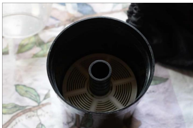
Slika 2.44: Bubanj za blokiranje svjetlosti
