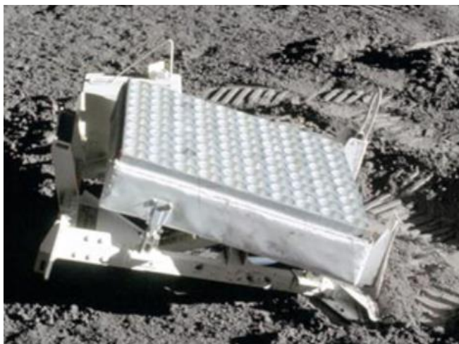
Slika 2.10 Reflektivni panel na površini Mjeseca, [14]
