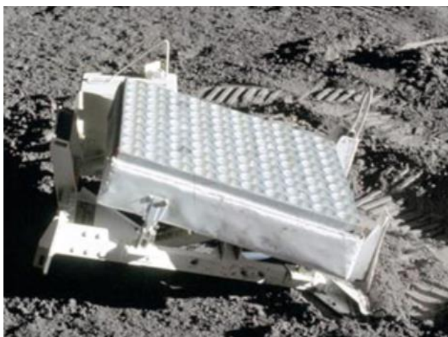
Slika 2.10 Reflektivni panel na površini Mjeseca, [14]
