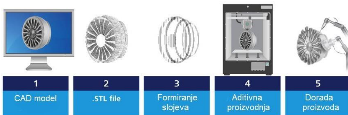
Slika 3.1 Proces aditivne proizvodnje [22]
