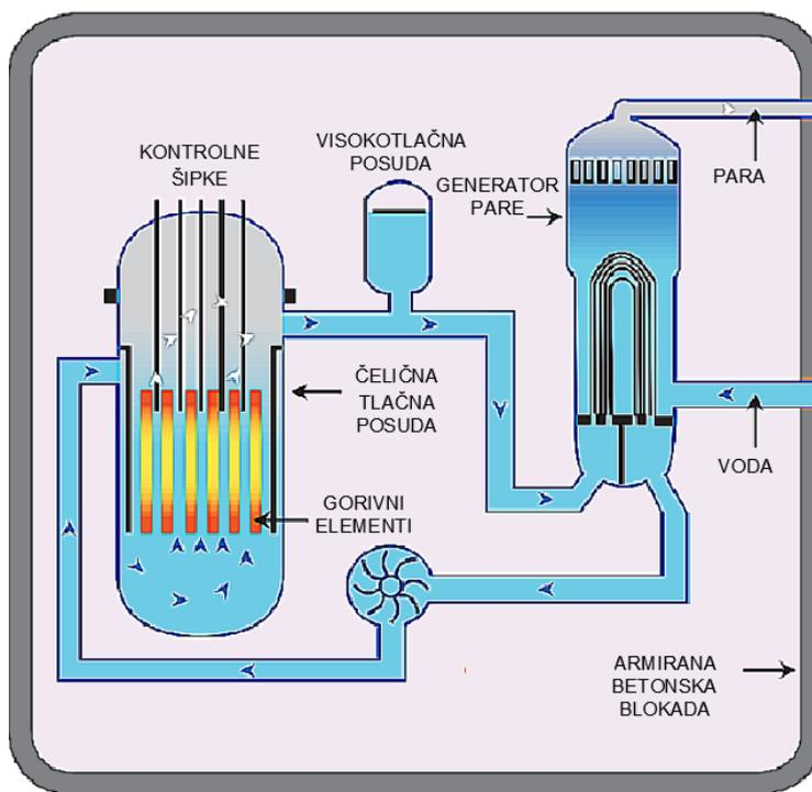
Slika 6.1 Prikaz komponenti PWR reaktora [9]
