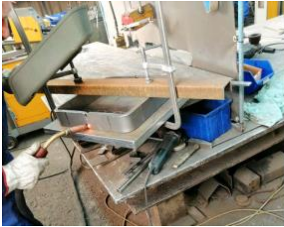
Slika 40. Bravarska montaža postolja
