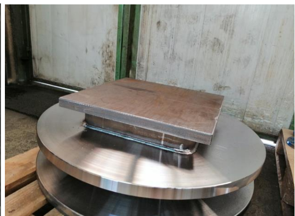
Slika 42. Postolje nakon bravarske montaže i zavarivanja
