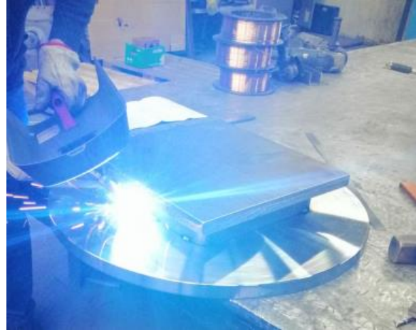
Slika 40. Bravarska montaža postolja
