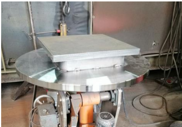
Slika 42. Postolje nakon bravarske montaže i zavarivanja
