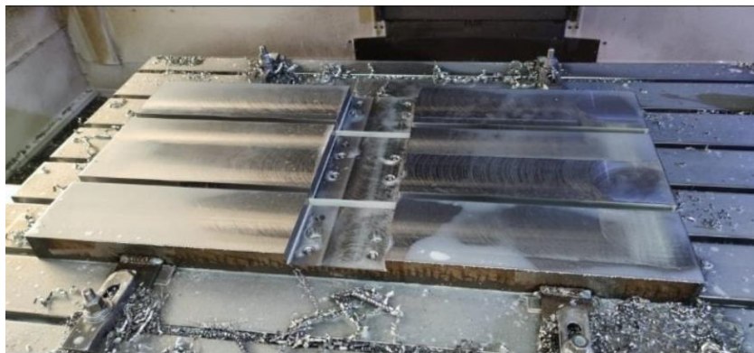
Slika 45. Ploča 1000x500x50 nakon obrade glodanjem
