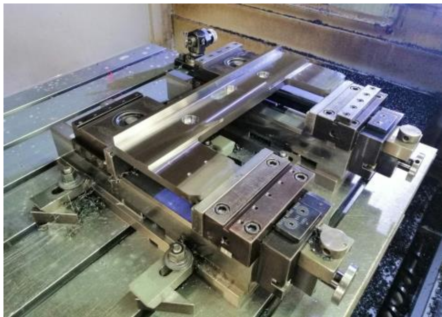
Slika 48. Ploča nosača stezaljki nakon obrade glodanjem
