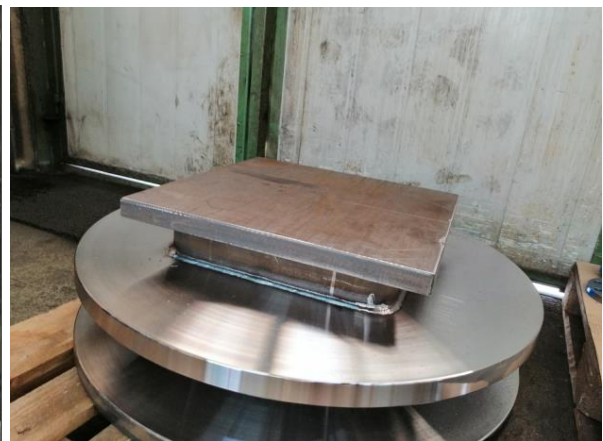
Slika 42. Postolje nakon bravarske montaže i zavarivanja
