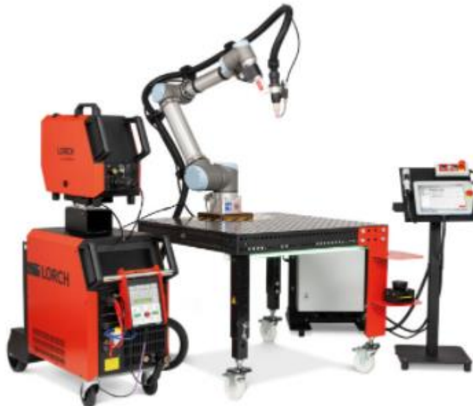
Slika 5. Stanica za robotsko zavarivanje [16]
