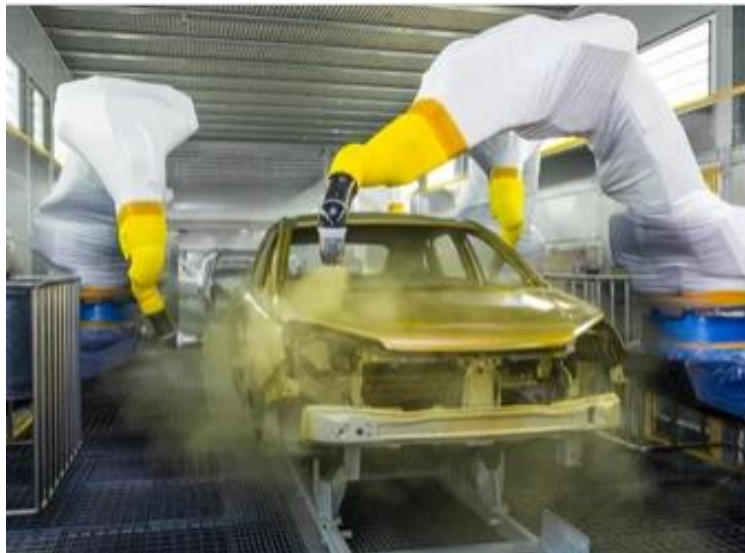
Slika 4. Primjena robota u procesu lakiranja automobila [12]
