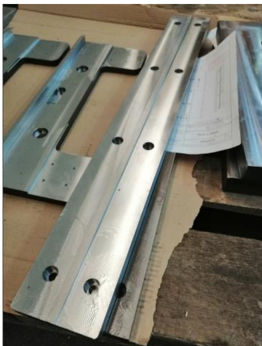
Slika 46. Ploča 1100x150x50 nakon obrade glodanjem
