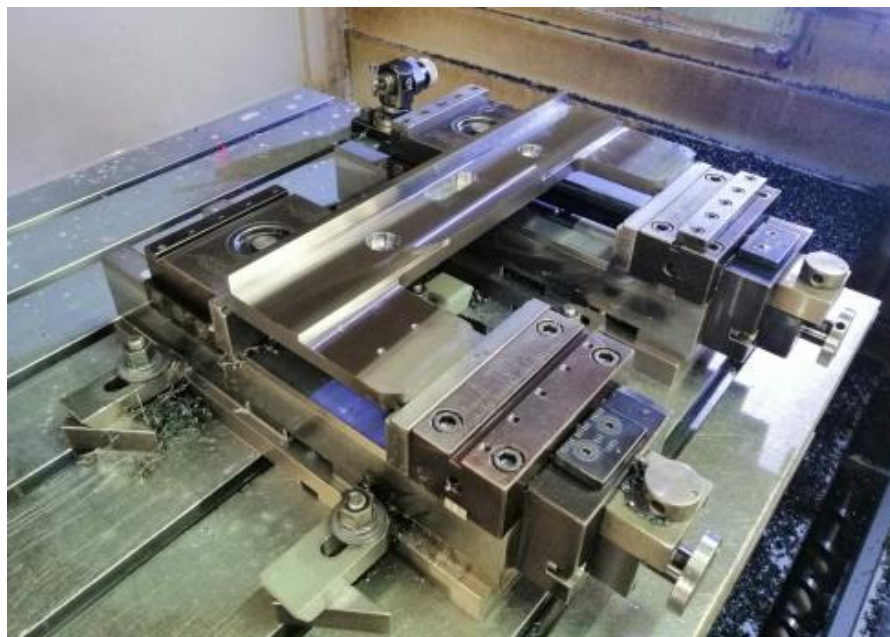
Slika 48. Ploča nosača stezaljki nakon obrade glodanjem
