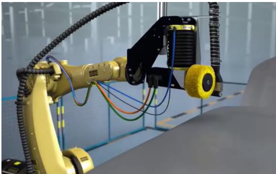
Slika 7. Robot nosi uređaj za brušenje prema radnom predmetu [18]
