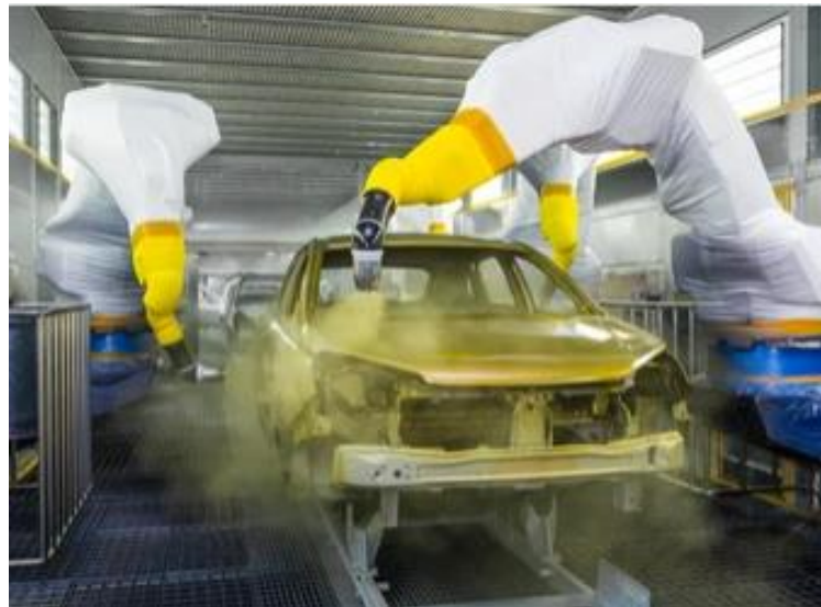
Slika 4. Primjena robota u procesu lakiranja automobila [12]
