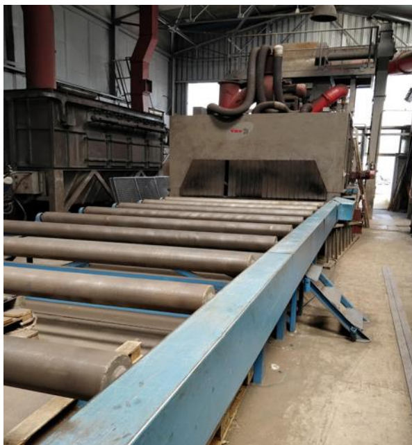
Slika 36. Protočna sačmara TST P-2500
