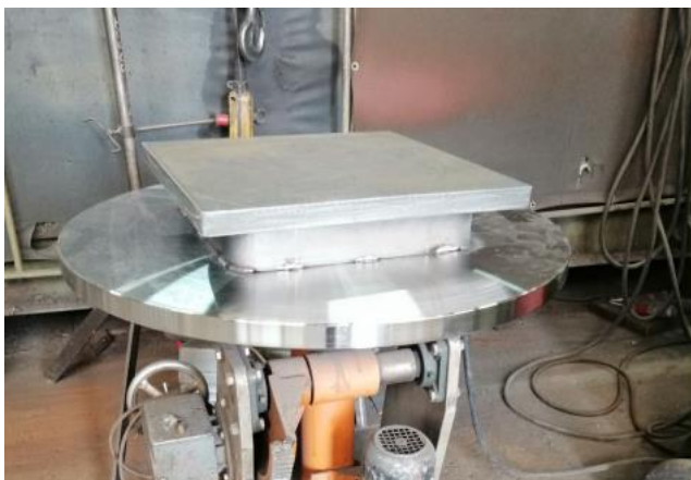
Slika 42. Postolje nakon bravarske montaže i zavarivanja
