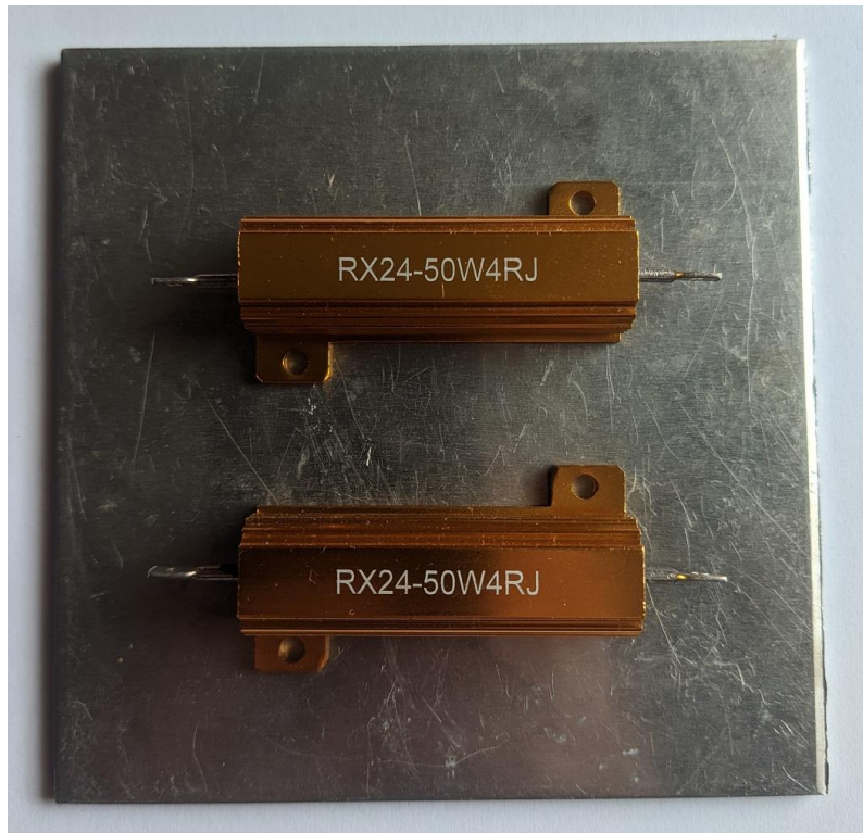
Slika 6.5 Otpornici korišteni za testiranje
