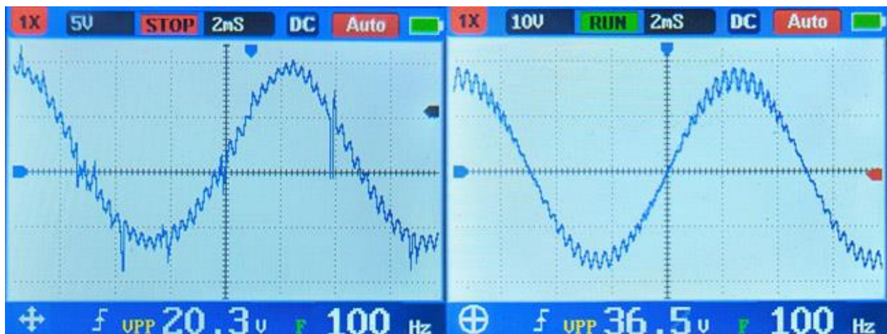
Slika 6.4 Izlaz pojačala iz ovog rada (lijevo) i komercijalnog rješenja (TPA3118), f=100\text{Hz}
