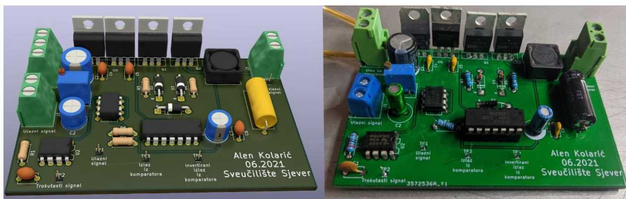
Slika 5.17 3D prikaz pločice (lijevo) i stvarna slika pločice (desno)
