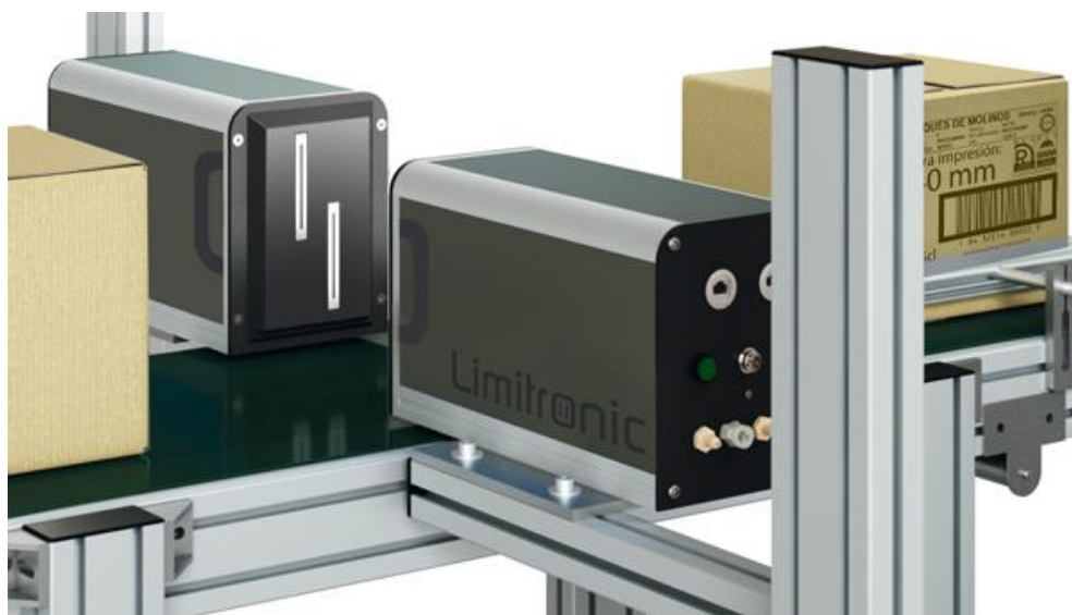
Slika 13. v6 spot multi-block pisač, izvor: limitronic.com
