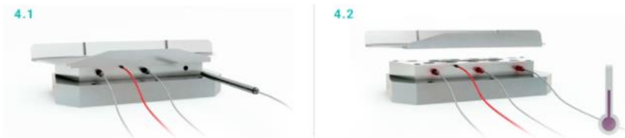
Slika 5.6 Demontaža stezne naprave [34]
