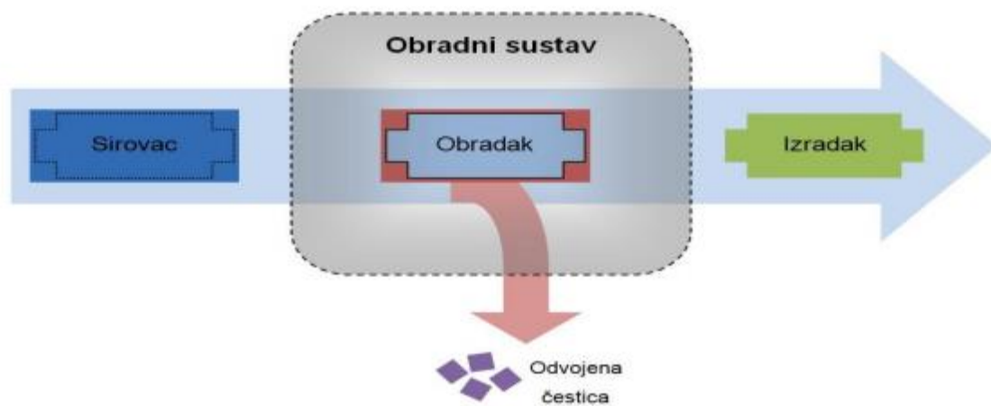
Slika 1.1 Obrada odvajanjem čestica [2]
