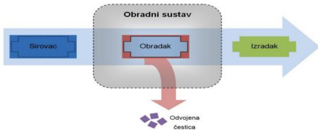
Slika 1.1 Obrada odvajanjem čestica [2]
