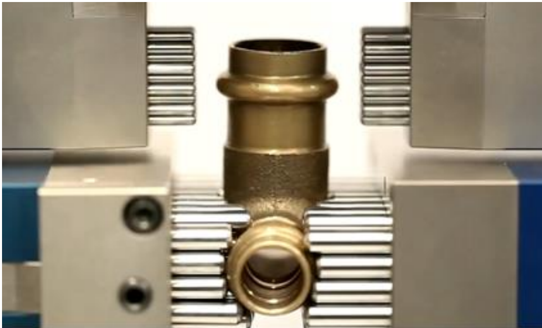
Slika 5.13 Pritezanje obratka MATRIX steznom napravom [36]
