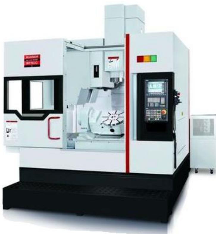
Slika 3.12 Glodaći obradni centar s pet upravljanih osi [23]
