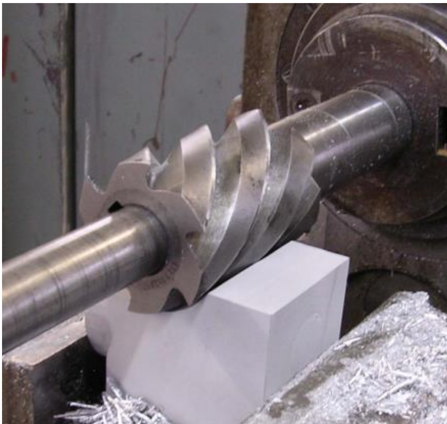
Slika 3.3 Istosmjerno obodno glodanje [9]
