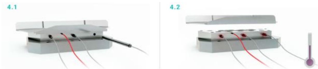
Slika 5.6 Demontaža stezne naprave [34]
