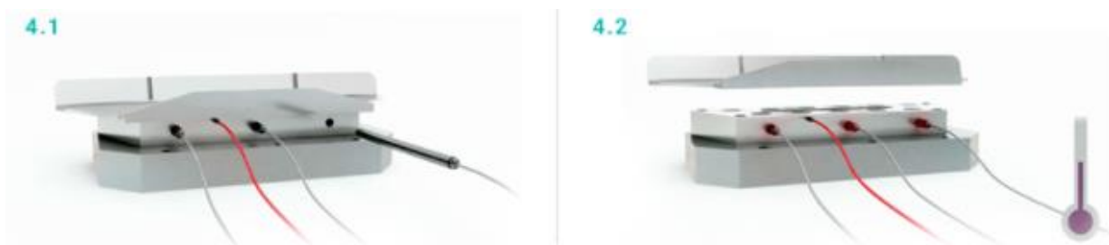
Slika 5.6 Demontaža stezne naprave [34]
