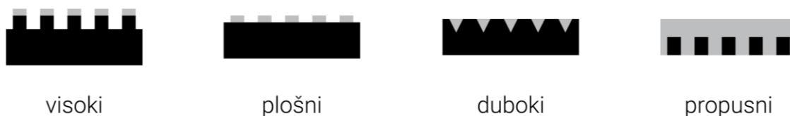
Slika 3.2: Izgled tiskovnih formi za klasične tehnike tiska
