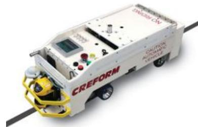
Slika 11. AGV vozilo s optičkim vođenjem
