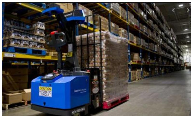
Slika 14. Prikaz AGV vozila tvrtke „Seegrid“
