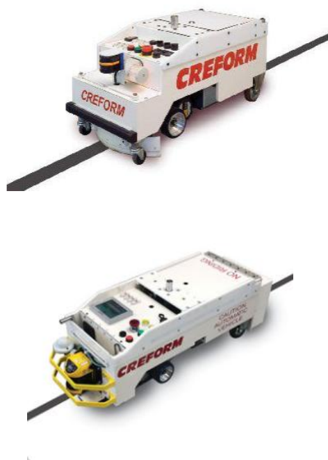
Slika 11. AGV vozilo s optičkim vođenjem
