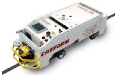
Slika 11. AGV vozilo s optičkim vođenjem
