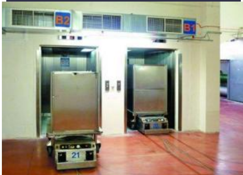
Slika 8. Prikaz mehaničkog vođenja
