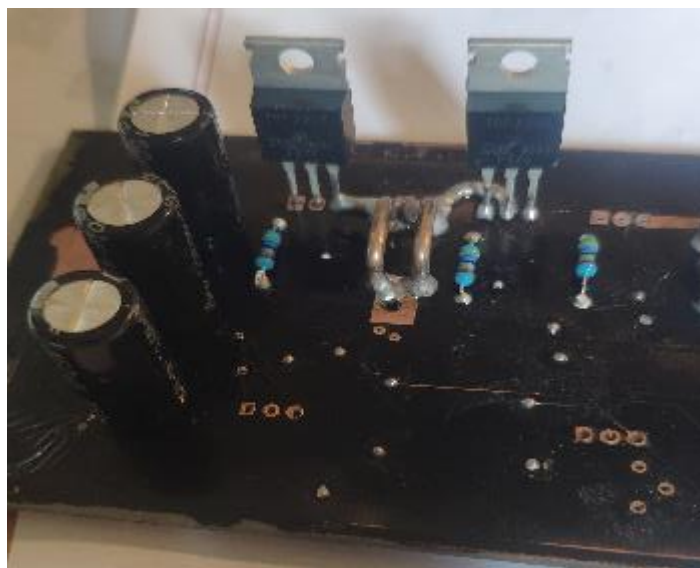
Slika 5.8-zalemljene komponente sa gornje strane pločice
