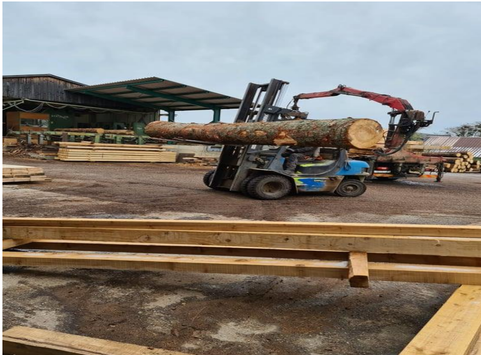
Slika 5. 9 Prijenos trupca sa viličarom do proizvodnog pogona
