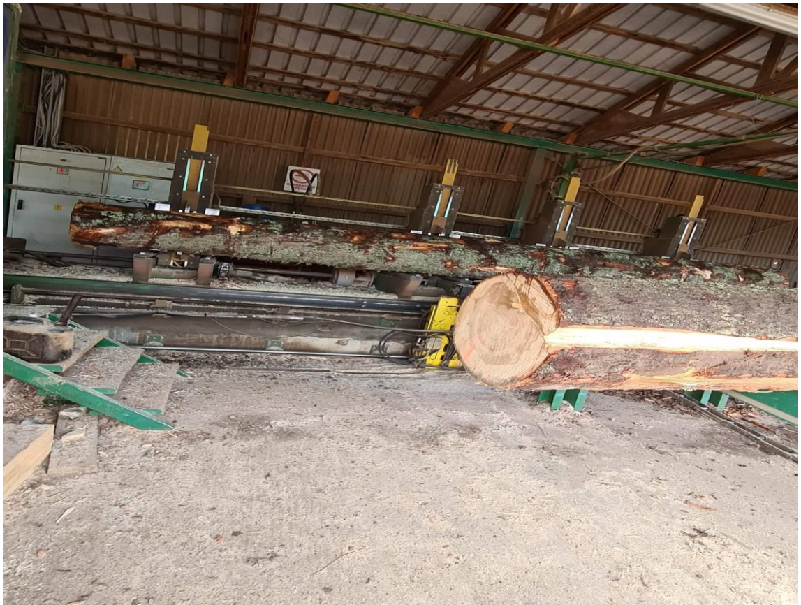
Slika 5. 12 Trupac na pokretnoj traci
