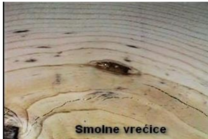
Slika 4. 5 Smolne vrećice – primjer [14]
