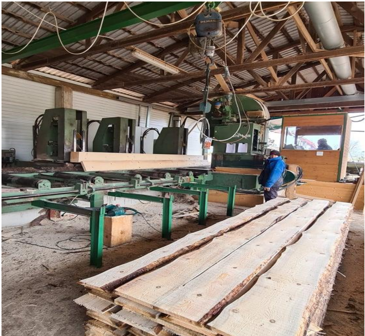
Slika 5. 19 Vertikalna tračna pila u završnoj fazi prerade trupca u gredu
