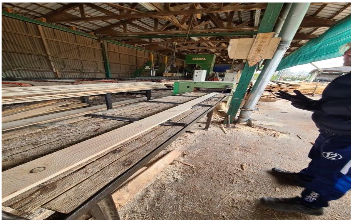
Slika 5. 18 Dio trupca višelisni cirkular pili u dasku
