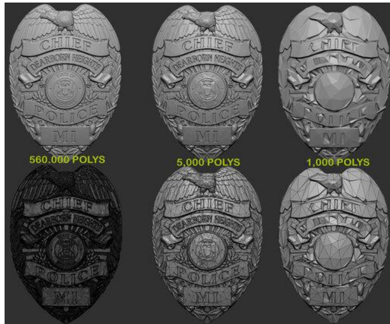
Slika 2 Razlika između visokih i niskih broja poligona[19]
