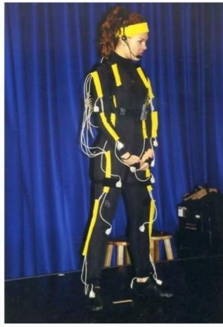
Slika 23 Oprema magnetskog sustava za hvatanje pokreta, izvor:
