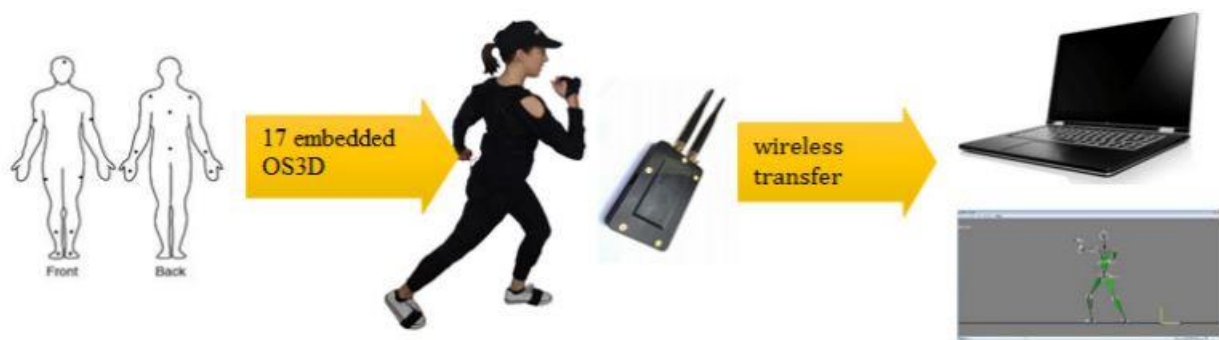
Slika 29 Struktura i sučelje sustava za snimanje pokreta [5]
