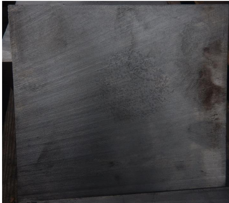
Slika 2.20 Područje chunky grafita nakon rezanja odljevka [7]
