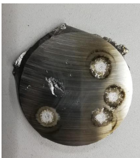
Slika 3.9 Ispitni uzorak za kemijsku analizu [7]
