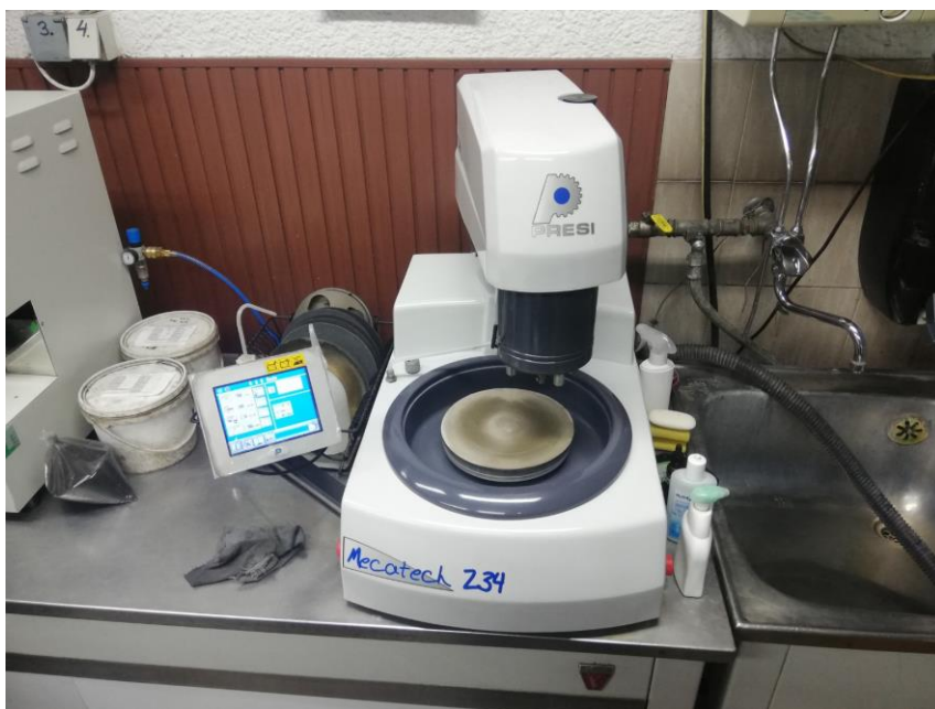
Slika 3.13 Uređaj za brušenje i poliranje metalografskih uzoraka [7]
