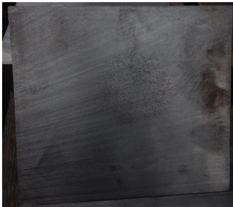
Slika 2.20 Područje chunky grafita nakon rezanja odljevka [7]
