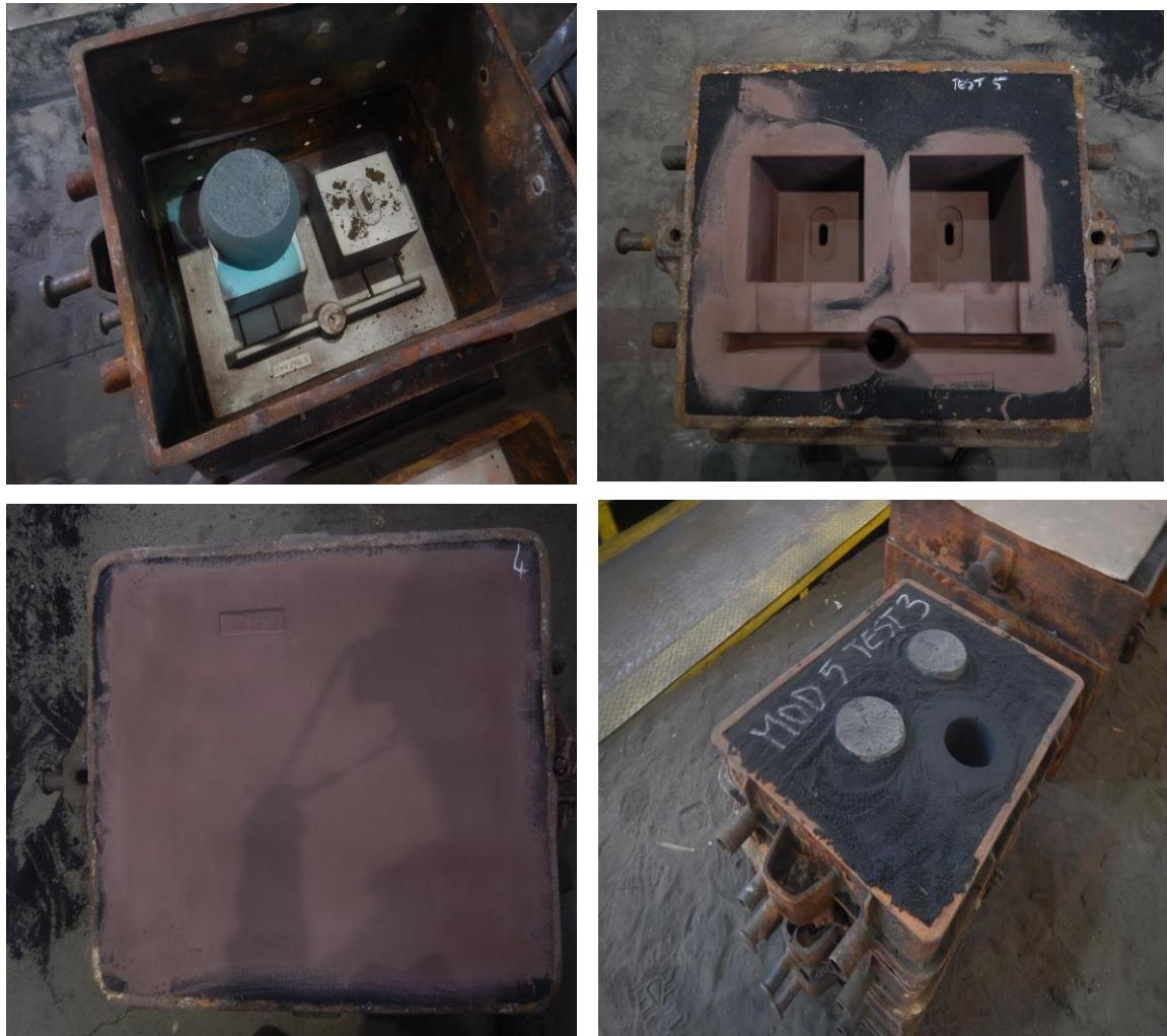
Slika 3.7 Kalup za lijevanje ispitnog uzorka [7]
