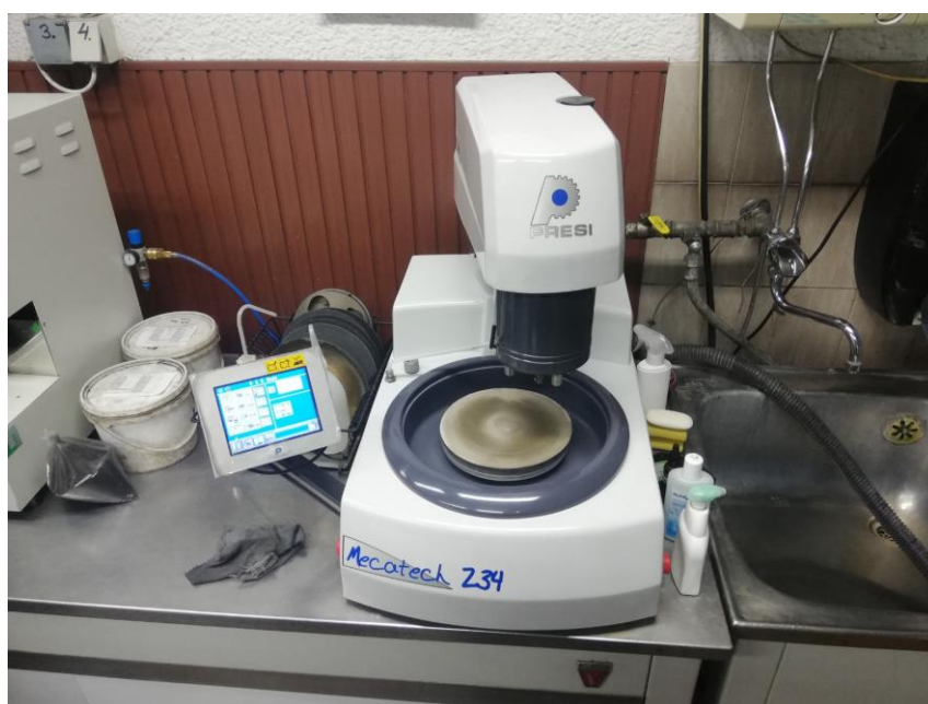
Slika 3.13 Uređaj za brušenje i poliranje metalografskih uzoraka [7]
