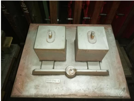
Slika 3.1 Model i nacrt kocke [7]
