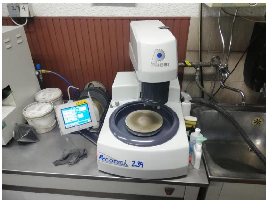
Slika 3.13 Uredaj za brušenje i poliranje metalografskih uzoraka [7]
