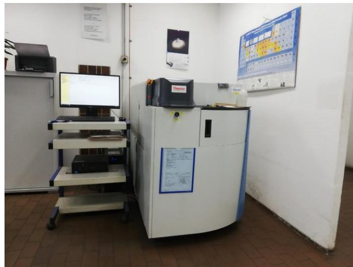
Slika 3.8 Optički spektrometar [7]
