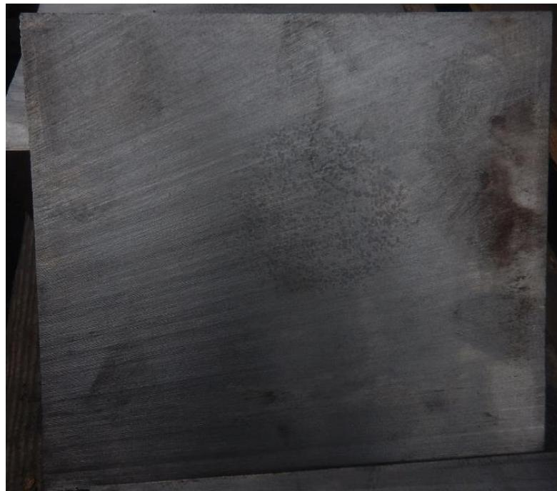
Slika 2.20 Područje chunky grafta nakon rezanja odljevka [7]
